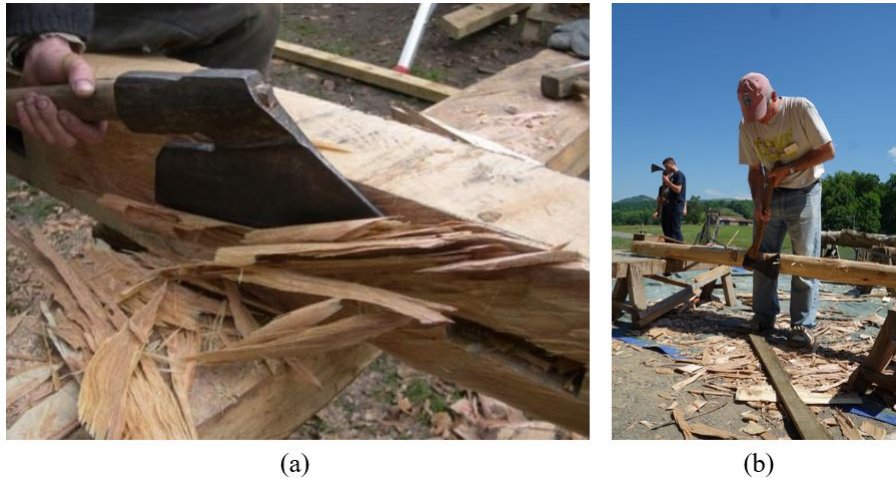
FIGURE 2.2 – Equarrissage à la hache : (a) ©F. Calame de Charpentiers Sans Frontières et (b) J. Gril pendant l'école thématique Pluribois 2022.
