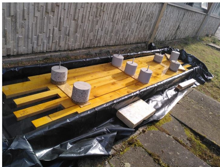
FIGURE 3.15 – Bassin d'immersion des poutres pour réhumidification.
