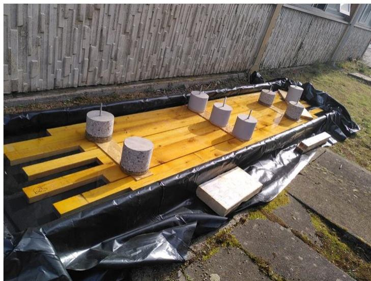
**FIGURE 3.15** – Bassin d'immersion des poutres pour réhumidification.
