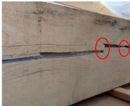
**FIGURE 7.13** – Fusion de deux fissures entourée en rouge sur la poutre S09.
