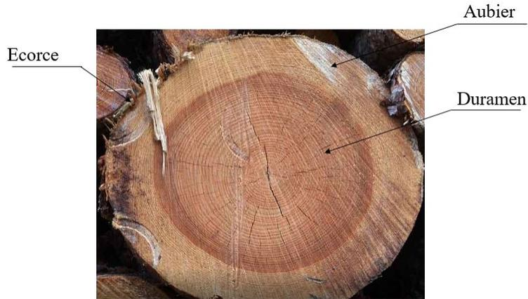
**FIGURE 1.1** – Illustration de l’aubier, du duramen et de l’écorce sur une grume de pin sylvestre à aubier différencié.
