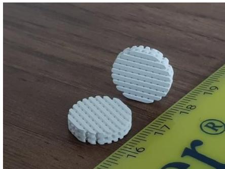
Figure 26 : Image des échantillons de 3Y-TZP structurés après impression par DLP
