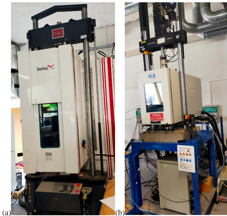
Figure 5-1 : (a) Presse MTS de \pm 250\text{ kN} équipée d'une enceinte thermique Ineltec et (b) presse Instron de \pm 25\text{ kN} équipée d'une enceinte thermique BIA Climatic
