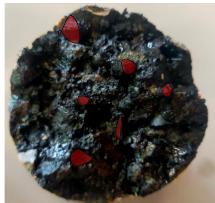
Figure 7-15 : Photographies des surfaces de rupture de l'éprouvette GB5-4-3550-2-6, testée en TSRST (les granulats de caoutchouc sont mis en évidence par un remplissage en rouge)
