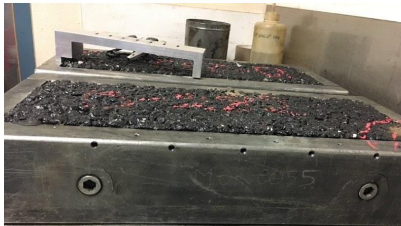
Figure 2-15 : Photographie d'une plaque de GB5 avec bitume modifié et 2% de CR incorporé par voie sèche et du système de mesure de l'épaisseur
