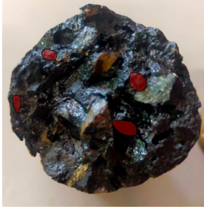
Figure 7-14 : Photographies des surfaces de rupture de l'éprouvette GB5-2-3550-2-5, testée en TSRST (les granulats de caoutchouc sont mis en évidence par un remplissage en rouge)
