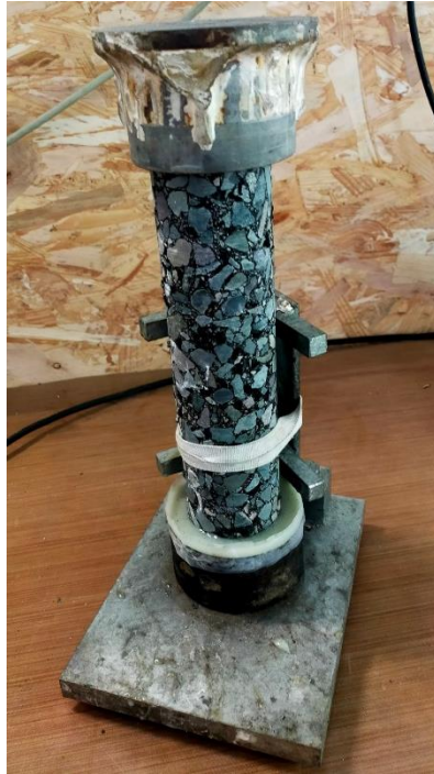
Figure 5-4 : Epreuve positionnée sur le banc de collage lors de la phase de séchage de la colle
