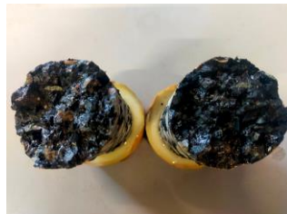
GB5-4-3550-2-6 (rupture lors d'un essai de TSRST)
