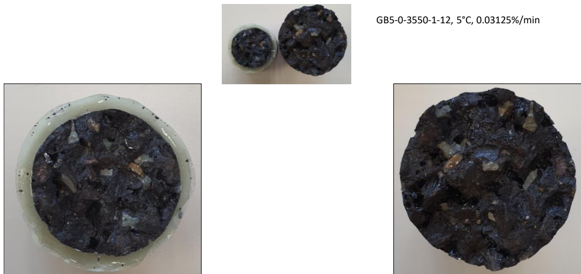
Figure 7-8 : Photographies des interfaces de rupture de l'éprouvette GB5-0-3550-1-12, testée en traction directe à 5 °C et pour une vitesse de déformation de 3,2 \times 10^{-2} \% /min
