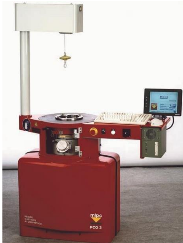
Figure 4-1 : Photographie d'une presse à cisaillement giratoire (source : ifsttar.fr)
