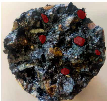
Figure 7-15 : Photographies des surfaces de rupture de l'éprouvette GB5-4-3550-2-6, testée en TSRST (les granulats de caoutchouc sont mis en évidence par un remplissage en rouge)
