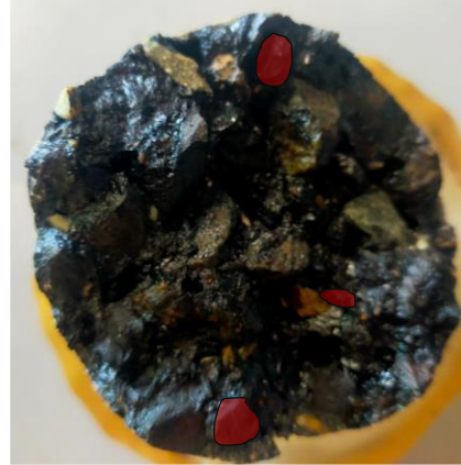
Figure 7-14 : Photographies des surfaces de rupture de l'éprouvette GB5-2-3550-2-5, testée en TSRST (les granulats de caoutchouc sont mis en évidence par un remplissage en rouge)
