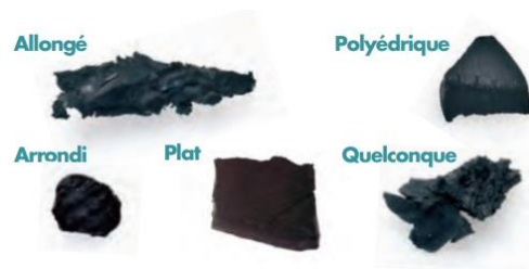
Figure 1-27 : Différentes formes de granulats de caoutchouc obtenus par broyage (Etude sur la morphologie des granulats commandée par ALIAPUR et réalisée par Le Bureau de Recherches Géologiques et Minières (BRGM - Orléans), le Centre de Transfert de Technologie du Mans (CTTM -Le Mans) et le Laboratoire de Recherche et de Contrôle du Caoutchouc et des Plastiques (LRCCP - Vitry.)
