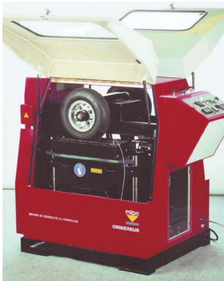
Figure 4-4 : Photographie d'un orniéreur de plaque (source : Ifsttar.fr)
