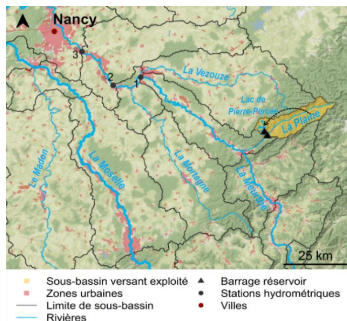
Figure 4.7 : Représentation du barrage de Pierre-Percée. Les stations hydrométriques sur la Meurthe en aval de l'ouvrage fortement influencées sont situées à 1 : Lunéville, 2 : Damelevières, 3 : Laneuveville. La flèche représente un transport actif de l'eau de la Plaine vers le barrage de Pierre-Percée.
