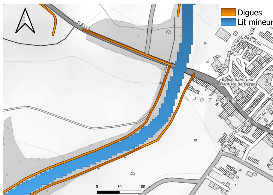
FIGURE 6.2 – Illustration de l'identification du lit mineur et des digues qui ont servi pour le ré-échantillonnage des MNT et pour la distinction du coefficient de rugosité entre lit mineur et lit majeur
