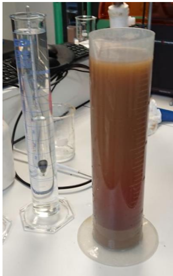
Figure IV-24 : densimètre plongé dans l'eau déionisée (à gauche) et éprouvette de sédimentation (à droite).
