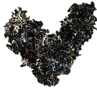
Figure V-13 : Cendres cristallines retrouvées dans le four en fin de pyrolyse
