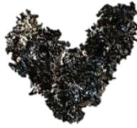
Figure V-13 : Cendres cristallines retrouvées dans le four en fin de pyrolyse
