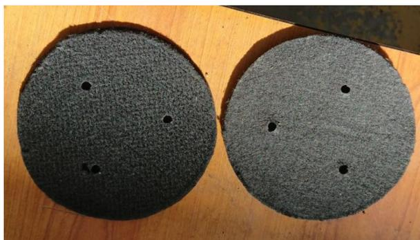
Figure IV-7 : différences de surface entre deux faces d'électrodes
