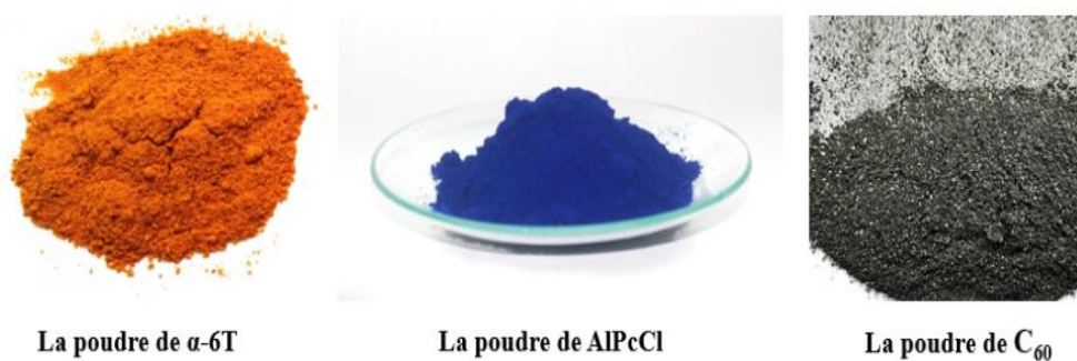
Figure II.2 – Poudres des matériaux organiques utilisés pour le dépôt des différentes couches actives étudiées lors du présent travail
