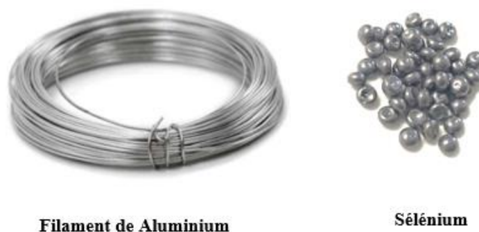
Figure II.3– Précurseurs utilisés pour le dépôt de la cathode et de la couche encapsulante
