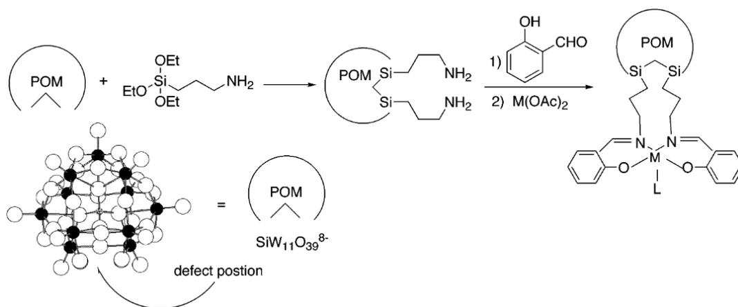
Figure 1-21 Voie de synthèse pour la préparation des composés  $M$ -Salen-POM,  $M = Mn, Co, Ni$  et  $Pd$ .
