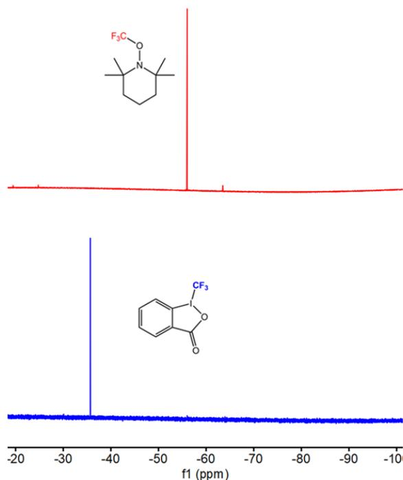
Figure 4-21 Spectre RMN  $^{19}\text{F}$  dans  $\text{CD}_3\text{CN}$  d'expériences de piégeage TEMPO pour la génération de radicaux  $\text{CF}_3$  avec le  $\text{D}_{\text{V3DPA}}\text{Cu}(\text{OAc})$  : TEMPO : Togni II = 1 : 1 : 1.
