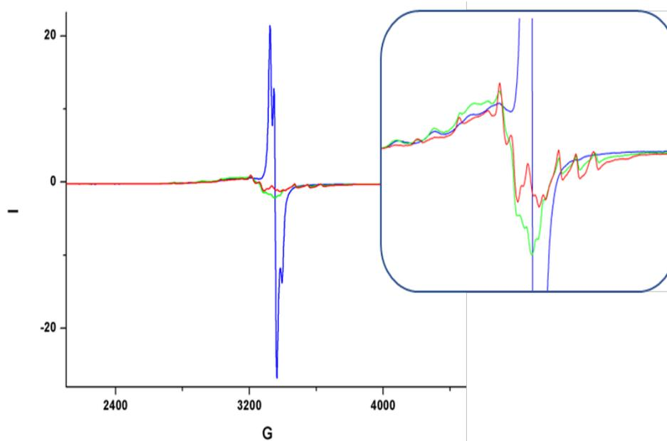
*Figure 4-22 Spectre RPE (bande X 9,4GHz 30K) dans l'acétonitrile d'expériences de piégeage de TEMPO pour la génération de radicaux  $CF_3$  avec le  $D_{V3DPA}Cu(OAc)$  : TEMPO : Togni II = 1 : 1 : 2 après une irradiation de 0- (bleu), 0,5- (vert) et 1 heure (rouge) avec de la lumière visible (> 382 nm)*
