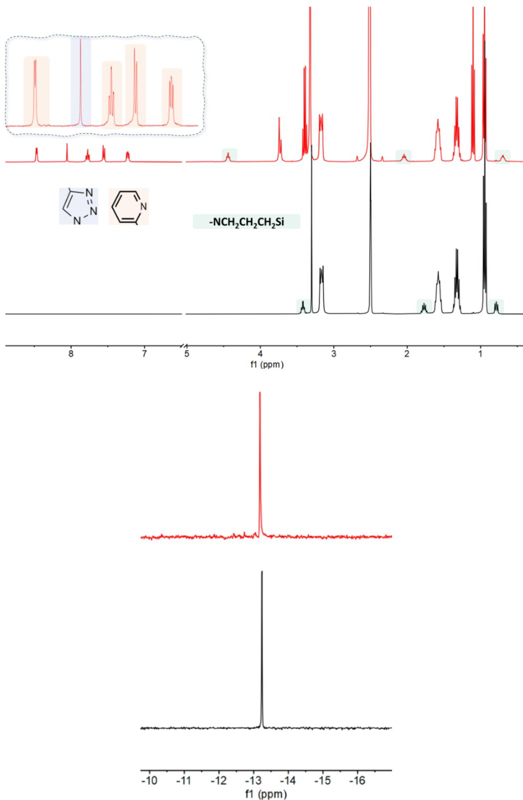
Figure 3-34 Comparaison de la RMN  $^1H$  et de la RMN  $^{31}P$  des  $K_{Si}[N_3DPA]-3$  (noir) et  $K_{Si}[N_3]-3$  (rouge) purifiés.
