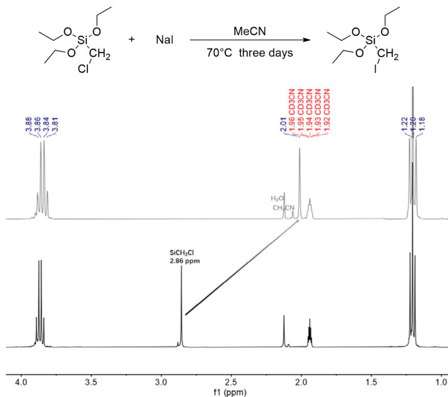
Figure 2-1 Spectre RMN  $^1\text{H}$  du triéthoxy(iodométhyl)silane (gris) et du triéthoxy(chlorométhyl)silane (noir) dans  $\text{CD}_3\text{CN}$ .
