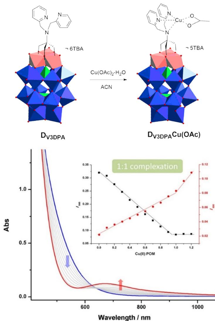
Figure 4-9 Titrage UV vis du  $D_{V3DPA}$  (1,0 mM) avec une quantité croissante de  $Cu(OAc)_2$ . Encart : évolution de l'absorbance à 540 nm et 690 nm avec le nombre d'équivalents de l'ion cuivre ajouté.
