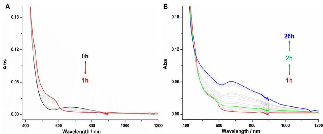
Figure 4-20 Évolution de la signature UV-VIS d'une solution 0,2 mM de **DV<sub>3</sub>DPA Cu(OAc)** dans l'acétonitrile lors de l'irradiation par la lumière visible. Les flèches mettent en évidence les changements successifs d'espèces associés à la photoréduction du complexe par 1, 2 ou 3 électrons.
