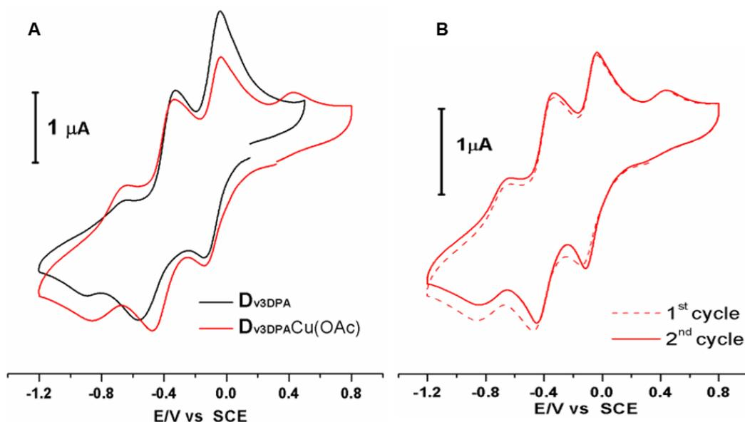
Figure 4-15 A) Voltammogrammes cycliques de  $D_{V3DPA}$  (noir) et de  $D_{V3DPA}Cu(OAc)$  (rouge) à  $1,0 \text{ mmol}\cdot\text{L}^{-1}$  dans  $CH_3CN$  contenant  $0,1 \text{ mol}\cdot\text{L}^{-1}$   $TBAPF_6$  et  $v = 100 \text{ mV}\cdot\text{s}^{-1}$ . B) Voltammogrammes cycliques de  $D_{V3DPA}Cu(OAc)$  premier cycle (tiret) et second cycle (solide).
