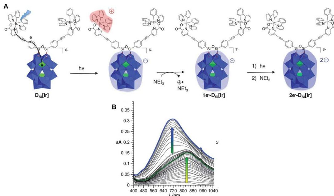
Figure 1-23 Hybride de POM de type Well-Dawson fonctionnalisé par un complexe d'iridium (III) et sa photoactivité dans l'évolution de l'hydrogène. A) Photo-accumulation de charges se produisant dans la dyade  $D_{Si}[Ir]$  ; B) évolution du spectre d'absorption différentielle dans le visible d'une solution de  $D_{Si}[Ir]$  (0,2 mM) dans du DMF contenant  $Et_3N$  (1 M) pendant la photo-irradiation sous lumière visible.
