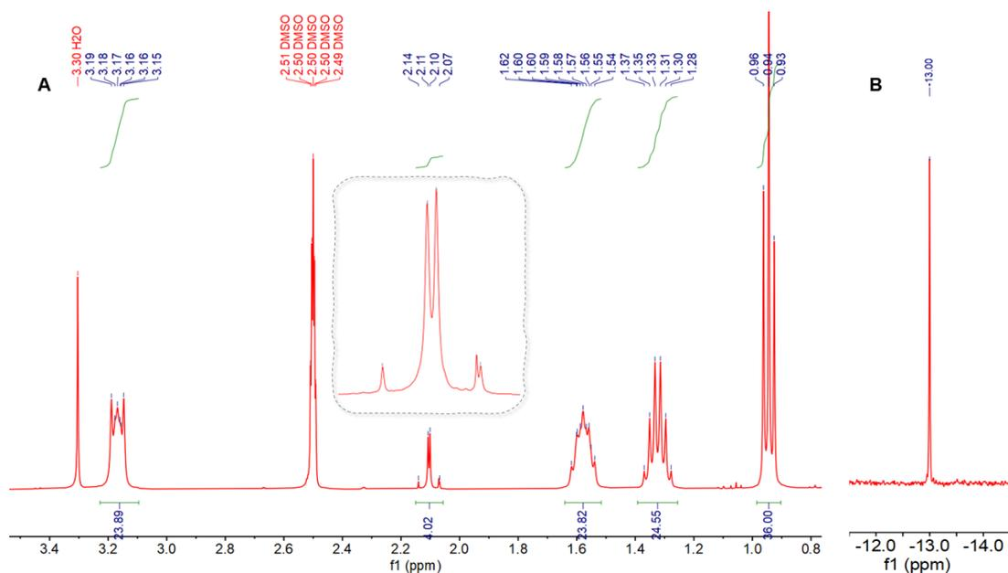
Figure 2-2 A) RMN  $^1\text{H}$  et B) RMN  $^{31}\text{P}$  de  $\text{K}_{\text{Si}}[\text{I}]-1$  dans du  $\text{DMSO}-d_6$
