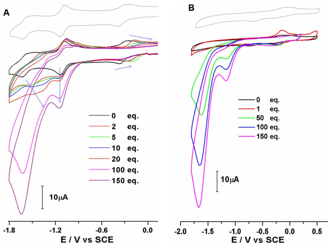
Figure 3-21 Voltammogramme cyclique de A) solution 0,45 mM de  $K_{Sn}[DPA]@Cu(OAc)_2$  en présence de (0, 2, 5, 10, 20, 100, 150 éq.) TBANO<sub>2</sub> ; B) solution 0,45 mM de propargyl DPA@Cu(OAc)<sub>2</sub> en présence de (0, 1, 50, 100, 150 éq.) TBANO<sub>2</sub> dans du DMF dégazé contenant 0,1 M de TBAPF<sub>6</sub>, vitesse de balayage : 100 mV/s, électrode de travail : carbone vitreux, électrode de référence : ECS.
