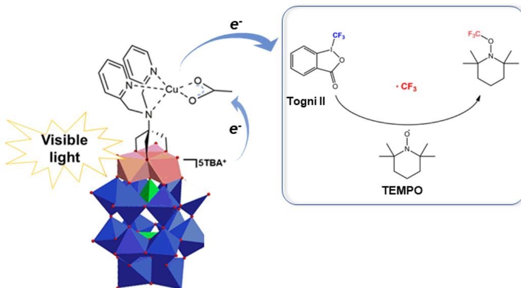
Ainsi, alors qu'aucune réaction ne se produit dans l'obscurité, l'irradiation à la lumière visible d'un mélange stœchiométrique de réactif de Togni (II) comme source de cation trifluorométhyle et d'anion **D<sub>V3DPA</sub> Cu(OAc)** (1,0 éq.) en présence du radical TEMPO a conduit,
