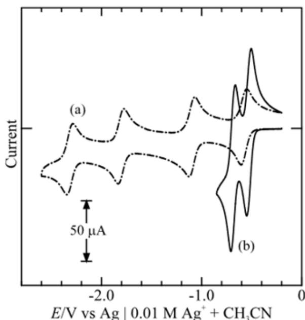
Figure 1-8 Voltammogrammes cycliques d'une solution 0.50 mM  $[PW_{12}O_{40}]^{3-}$  dans  $CH_3CN$  contenant 0.1 M  $n-Bu_4NClO_4$ ,  $[CF_3SO_3H]$  (a) 0 mM ; (b) 5.0 mM
