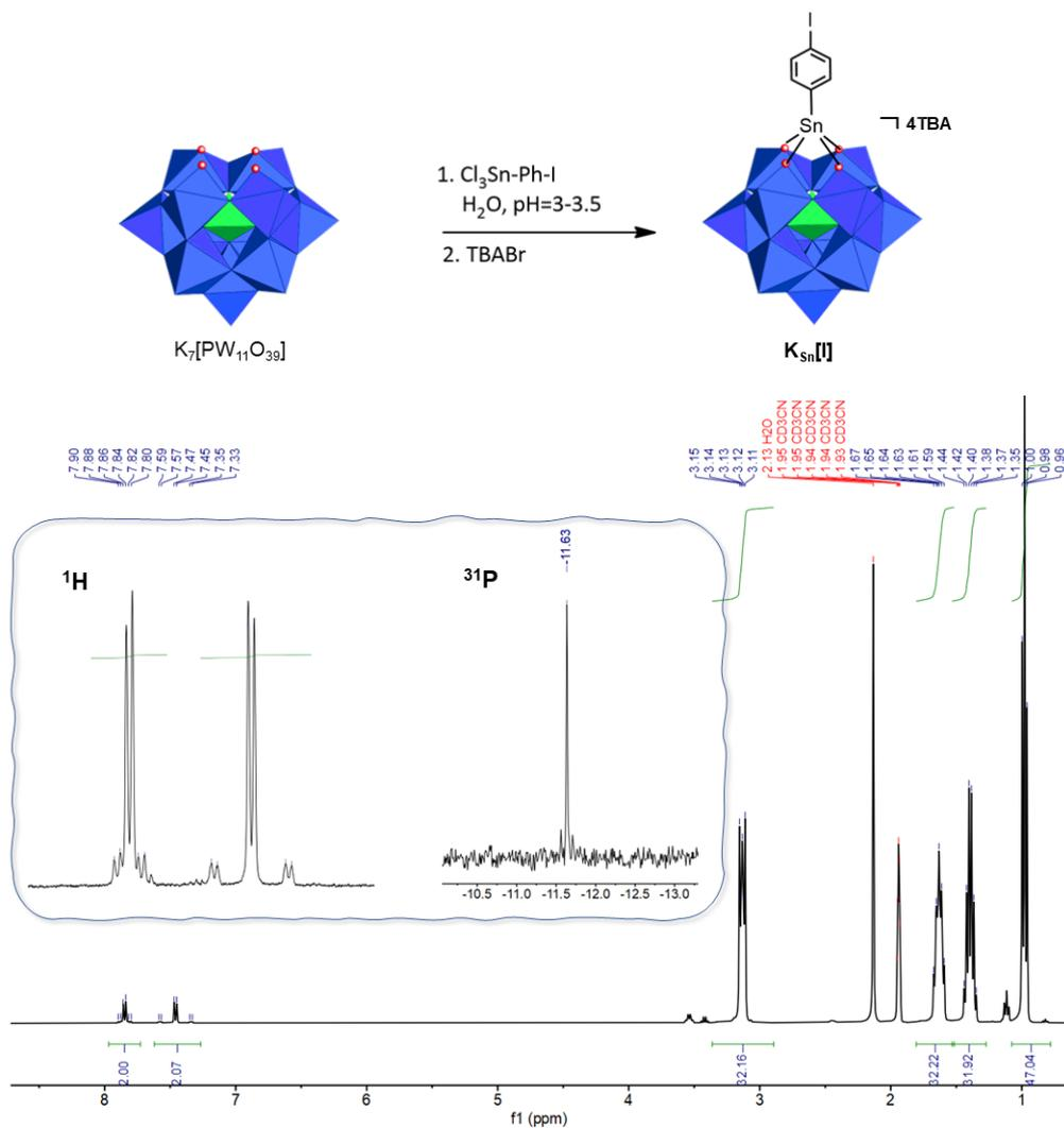
Figure 3-4  $^1H$  NMR et  $^{31}P$  NMR (insert) de  $K_{Sn}[I]$  dans  $CD_3CN$ .
