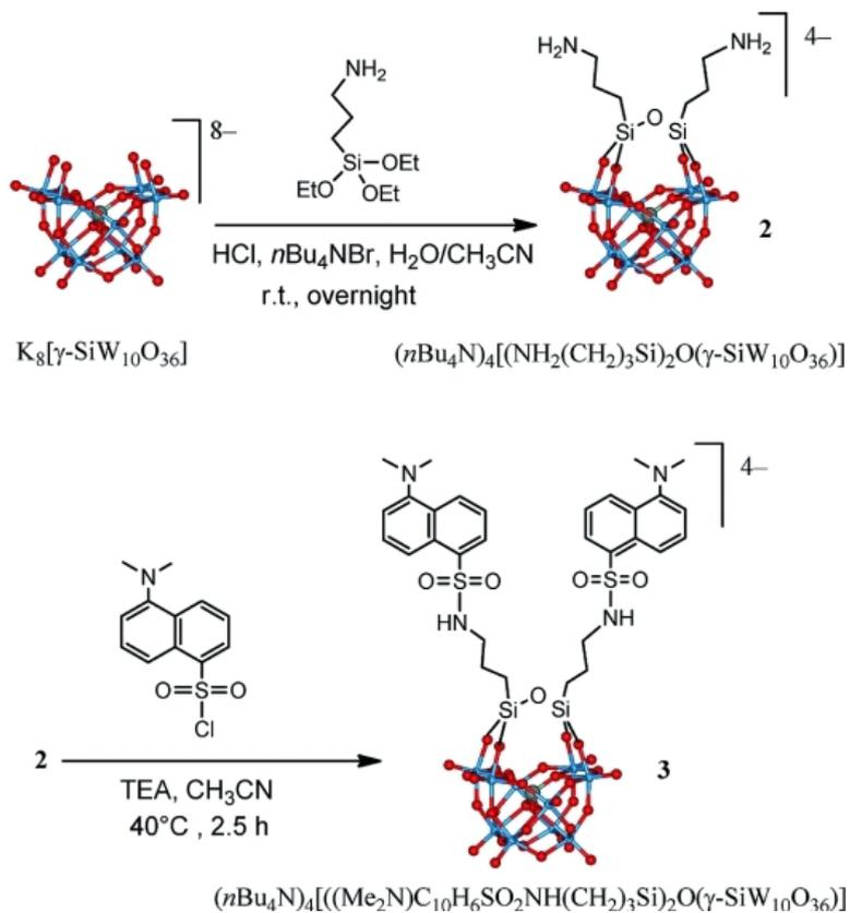
Figure 1-12 Etape 1 : synthèse de la plateforme à terminaison amine  $[\gamma-SiW_{10}O_{36}\{O(Si(CH_2)_3NH_2)_2\}]^{4-}$ . Etape 2 sa post-sulfonamidation.
