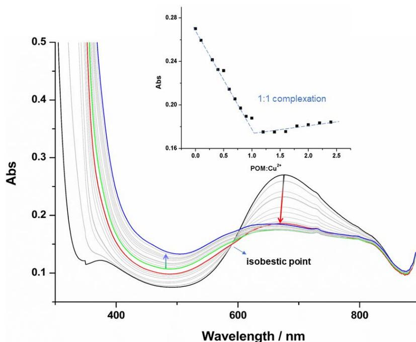
Figure 3-11 Titrage UV-vis de la complexation de 1.0 mM  $\text{Cu}(\text{OAc})_2$  avec  $\text{K}_{\text{Sn}}[\text{DPA}]$ .
