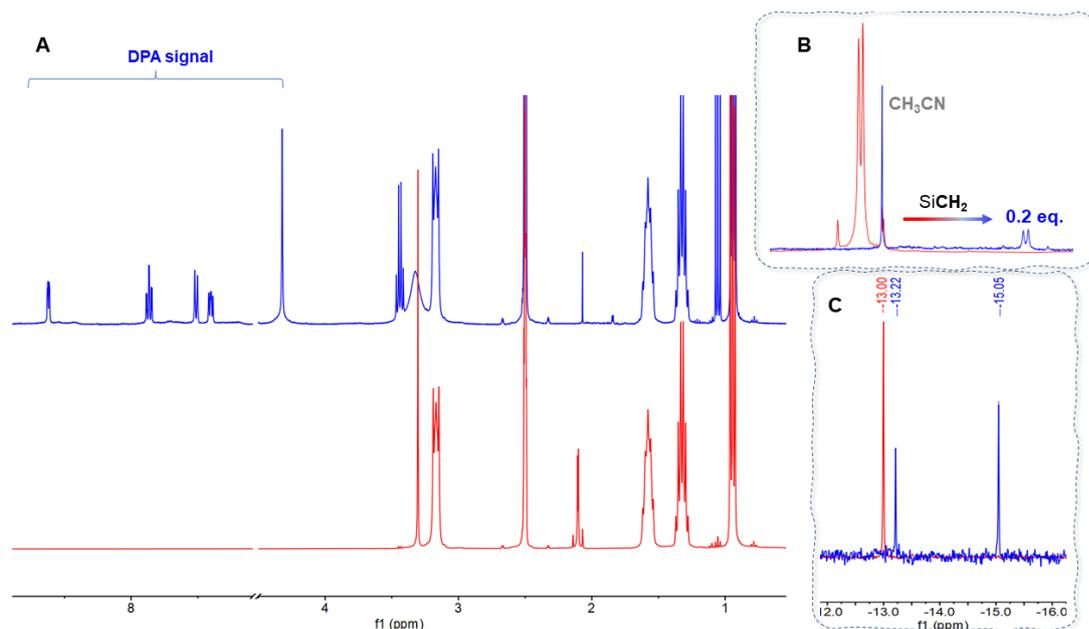
Figure 2-6 La gamme complète (A) et le zoom du SiCH<sub>2</sub> (B) du spectre <sup>1</sup>H NMR et <sup>31</sup>P NMR(C) du précurseur **K<sub>Si</sub>[I]-1** (rouge) et du **K<sub>Si</sub>[DPA]-1** synthétisé(bleu).
