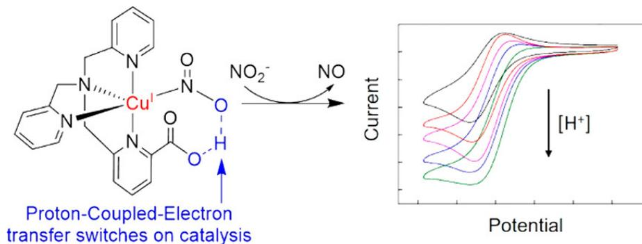
Figure 1-5 Les deux complexes tripodes de Cu donneurs de N bioinspirés et la proposition de mécanisme de transfert de protons couplés à des électrons pour le processus de réduction électrocatalytique du nitrite.
