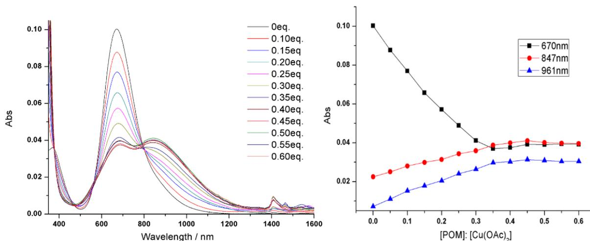
Figure 3-36 Le titrage UV-vis de 0,50 mM  $Cu(OAc)_2$  avec  $K_{Si}[N_3DPA]-3$  dans l'acétonitrile et la pente à 670, 847 et 961nm.
