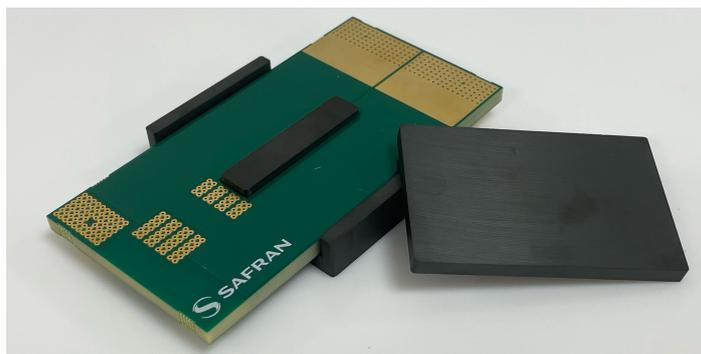
FIG. .2 Photographie d'un transformateur planaire réalisé dans le cadre de ces travaux de recherche.
