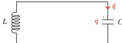
FIG. II.5 Schéma d'un oscillateur LC élémentaire.
