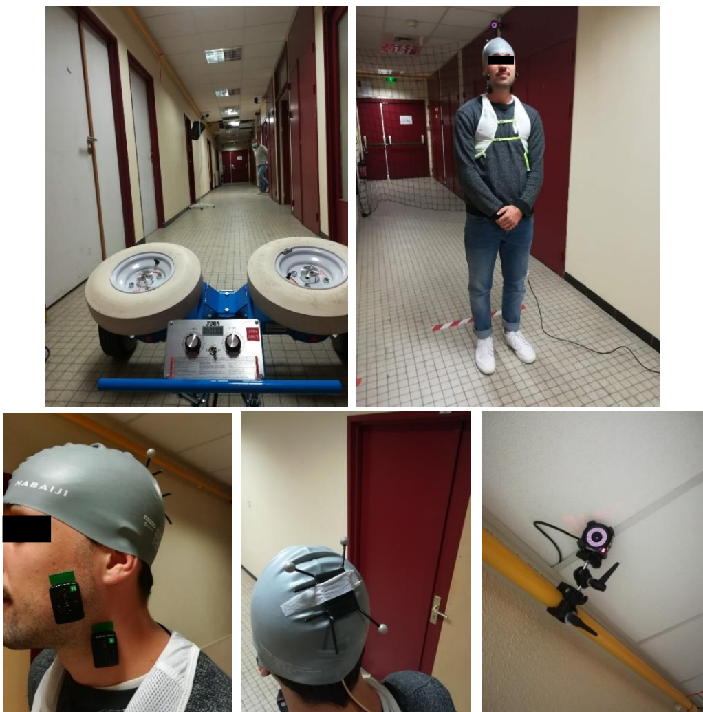
Figure 10: Installations/équipements sur la plateforme d'analyse du mouvement pour les sessions d'impacts tête-ballon.
