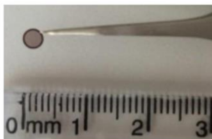
Figure 5: Photographie d'une grille de microscopie électronique en transmission à base de cuivre recouverte d'un film de carbone.
