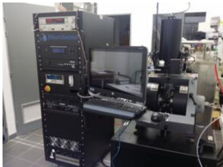
Figure 7: Magnétomètre à échantillon vibrant MICROSENSE EZ-7 : console électronique et ordinateur de contrôle (à gauche), électroaimant (à droite) présent au sein du groupe Molécules et Matériaux Commutables de l'ICMCB.
