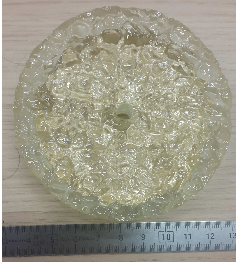
FIGURE 3.48 – Photographie du sol transparent en époxy réalisé à partir des données de topographie d'une chaussée réelle
