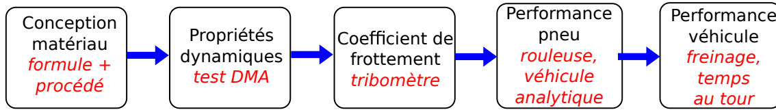
FIGURE 1.1 – Les différentes étapes de la conception d'un pneumatique
