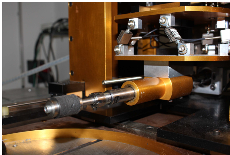
FIGURE 3.14 – Photographie de l'axe motorisé sur lequel est fixé le cylindre de gomme
