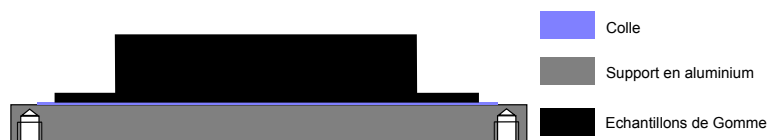
FIGURE 3.17 – Schéma d'un échantillon de gomme
