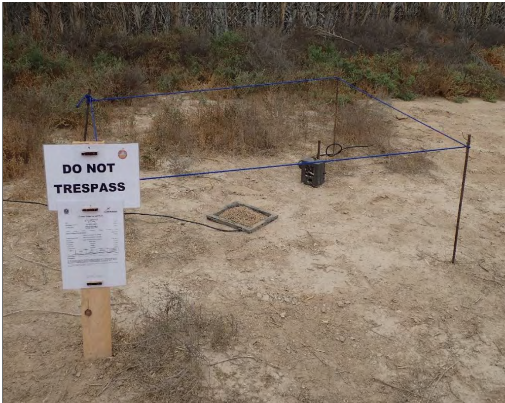
Figure 26. Point de détection installé en bord de route. Le décodeur et la batterie sont hors champs. Crédits : J. Hirschinger
