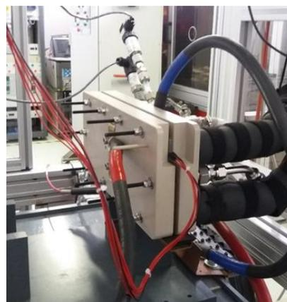
Figure I.4 - Photographie d'un stack PEM BT fourni par SAFRAN AEROSYSTEMS
