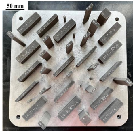
Figure 121 : Photographie du plateau imprimé dans l'alliage Al-Zn-Mg-Cu-Zr sur la machine Renishaw AM400 (Paramétrie de fabrication n°15).
