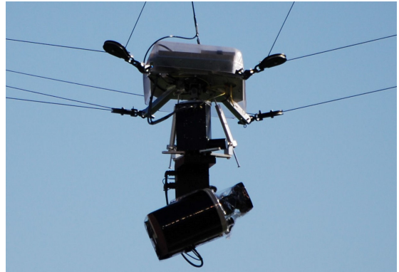
(b) RPC suspendus équipé d'une caméra
