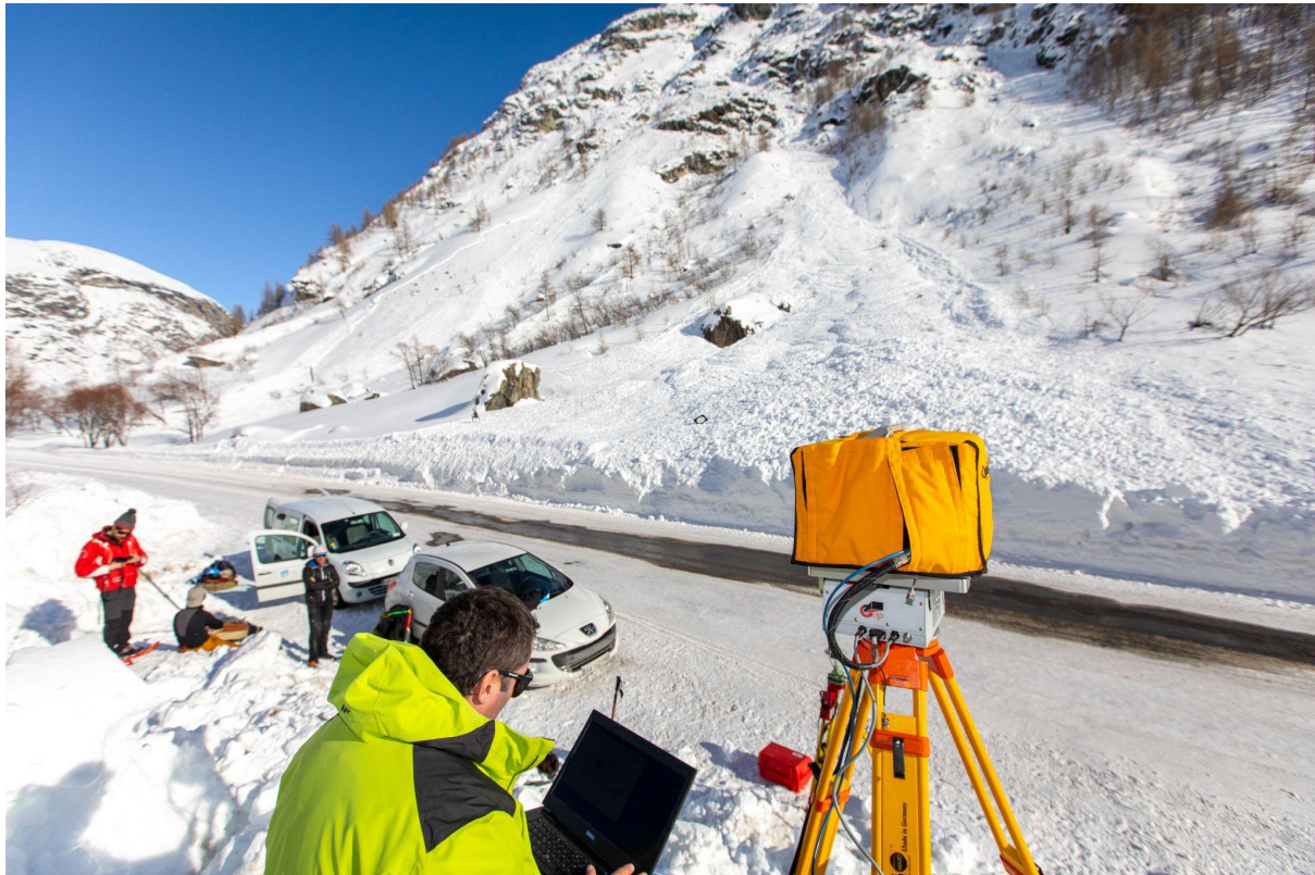
Figure 8 : Mise en place du Laser-scan pour obtenir le nuage de point nécessaire à la création du MNT d'un dépôt (© Thibaut VERGOZ / LGP / INRAE / CNRS Photothèque / 2019)
