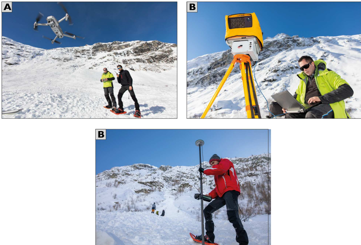
Figure 25 : Méthodes utilisés pour les mesures du volume et de la forme d'un dépôt d'avalanche : (a) vol d'un drone pour la réalisation d'une photogrammétrie 3D du dépôt (b) utilisation du Laser Scan, (c) GPS différentiel utilisés pour géoréférencer l'emprise du dépôt. (© Thibaut VERGOZ / LGP / INRAE / CNRS Photothèque / 2019)
