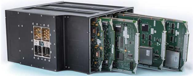
FIGURE 1.1 LRU dans l'ordinateur de contrôle de vol comportant 5 SRU
