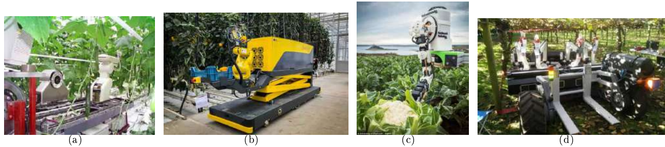
FIGURE 1.13 – Différentes structures de robot attachées à une même tâche de récolte pour des cultures distinctes. (a) Robot pour la récolte des concombres sous serre VAN HENTEN et al. (2003). (b) Robot Sweeper pour la récolte des poivrons sous serre ARAD et al. (2020). (c) Prototype de robot pour la récolte des choux-fleurs en plein champ PINKSTONE (2018). (d) Robot pour la récolte des kiwis dans les vergers SCARFE et al. (2009).
