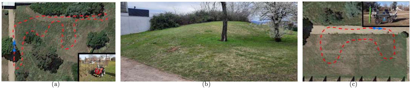
FIGURE 4.9 – Présentation des terrains d'essais expérimentaux. (a) : Trajectoire des essais sur le mobile skid-steering. (b) : Photos du terrain en pente sur lequel évoluait le mobile skid-steering lors des expérimentations. (c) : Trajectoire des essais sur le mobile voiture et le mobile à deux trains directeurs.
