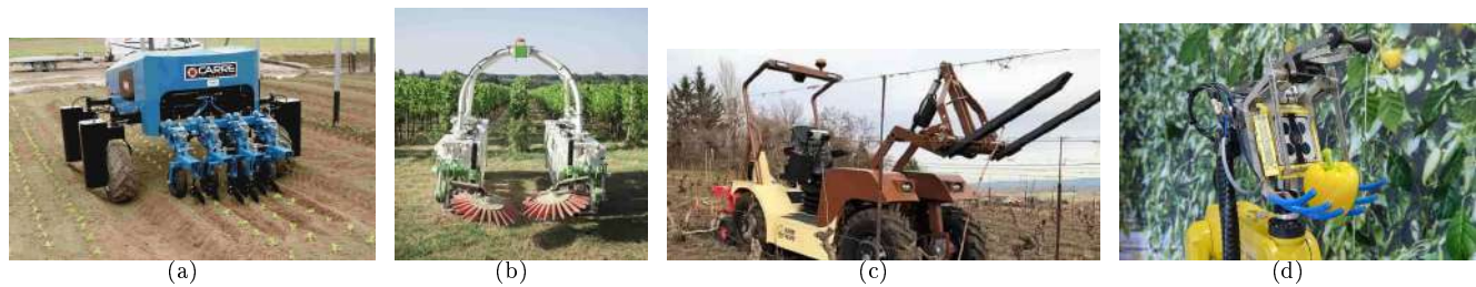
FIGURE 1.14 – Différents outils pour la réalisation autonome de tâches agricoles. (a) Outils de binage associé au robot Anatis de la société Carré. (b) Disque Cress pour le remplacement de la terre au pied des vignes monté sur le robot Ted de la société Nafo Technologies. (c) Chargeur monté sur le tracteur électrique Alpo de la société Sabi Agri. (d) Outils de détection et récolte des poivrons montés sur le robot Sweeper ARAD et al. (2020).
