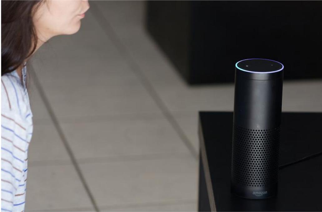
*Photographie 13 - Une utilisatrice active une enceinte Amazon Echo avec le mot de réveil "Alexa" et prononce sa requête. La diode circulaire s'allume en bleu et affiche une zone lumineuse blanche en direction de la source vocale (JFP, 2021)*
