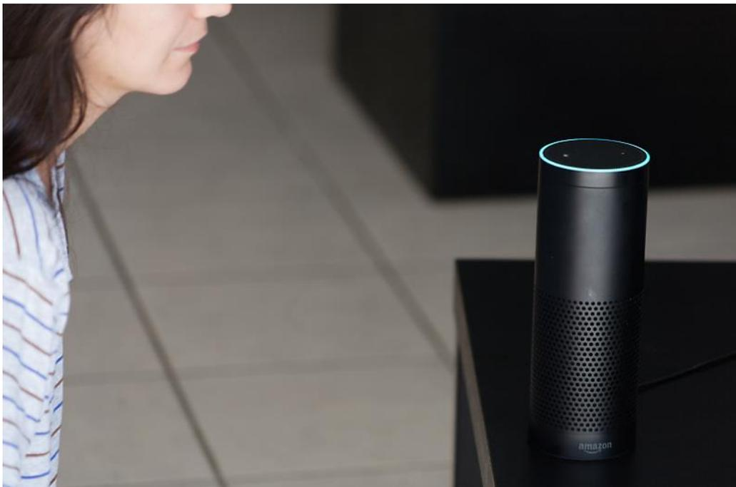
*Photographie 12 - L'utilisatrice s'étant tue, l'enceinte Echo signale qu'elle est en train de traiter la demande par un témoin lumineux faisant le tour de la diode circulaire, avant de donner sa réponse (JFP 2021)*
