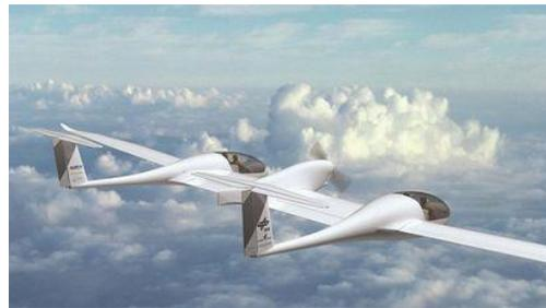
Figure 4. Le HY4 équipé d'une pile à combustible et d'un moteur électrique d'une puissance de 80 kW [23].
