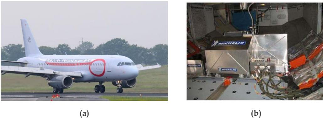
Figure 1.4. (a) Avion de recherche DLR A320 (D-ATRA) et (b) la pile Michelin installée dans la zone cargo de l'avion [15]
