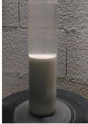
FIGURE 3.1 – Photographie de l'éprouvette remplie d'eau avec, au fond, des grains de zircon immergés.
