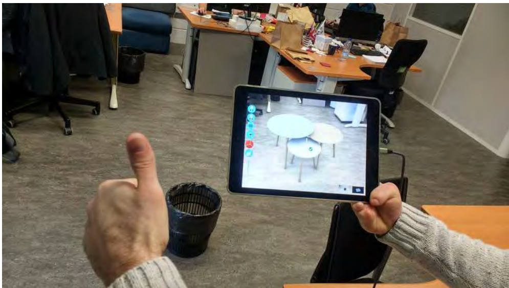
FIGURE 1.7 – Exemple de rendu de SwapUp : une application de réalité diminuée d’Innersense présentée dans le chapitre 8.
