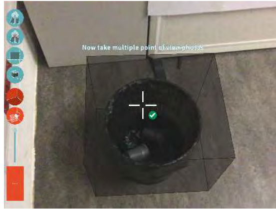
FIGURE 8.3 – Création du masque 3D. L’application guide l’utilisateur durant la création du masque 3D sous la forme d’un cube. Premièrement, l’utilisateur sélectionne un coin du cube qui appartient au sol. Ensuite, l’utilisateur délimite le masque selon les trois axes de direction des arêtes du cube. D’abord la délimitation se fait selon les deux axes horizontaux (un axe puis un autre) puis se finit avec l’axe vertical.
