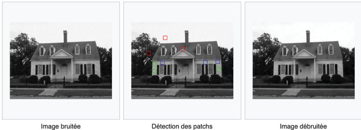
Figure 25: Exemple de débruitage grâce à un filtre moyen non local ( NLMF) [139].
