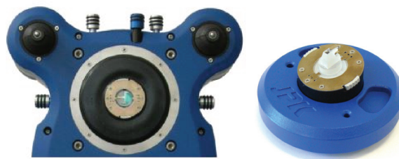
FIGURE 3.4 – À Gauche : le scanner qui porte le bloc en verre. À droite : le bloc en verre qui porte le levier.
