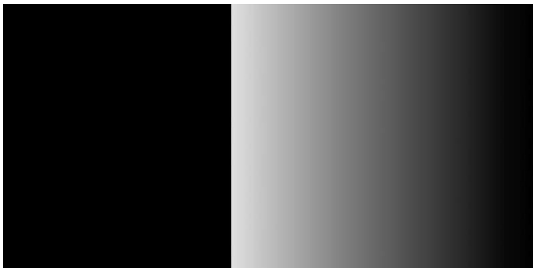
FIGURE 4.8 – Résultat obtenu. Plus l’intensité est élevée, plus le trait laser est bas sur l’image initiale. Les pixels ont été convertis du format 16 bits au format 8 bits afin de pouvoir être visible sur le manuscrit.
