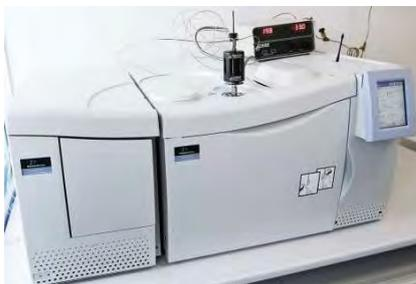
Figure 2-20 : Couplage d'un pyrolyseur avec GC/MS
