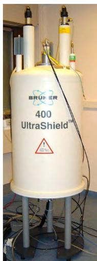
Figure 2-22 : Spectromètre RMN solide - Bruker Avance III WB 400
