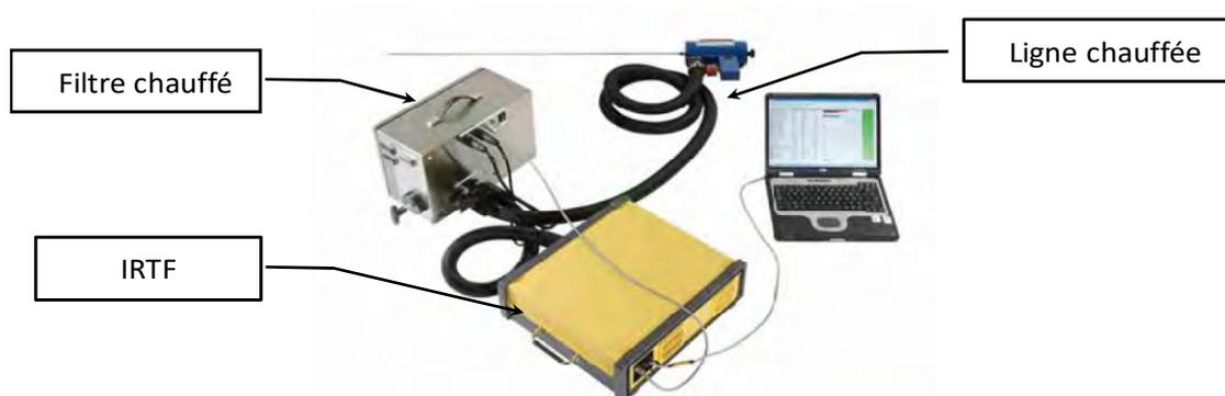
Figure 2-18 : Dispositif de prélèvement et d'analyse IRTF d'un gaz (Gasmét, Finlande)
