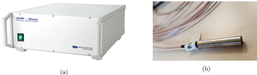
FIGURE 2.18 – (a) Photo de l'appareil de mesure : Ultrasound Velocity Profiler UVP-Duo (image Met-Flow). (b) Photo d'une sonde UVP 4 MHz de diamètre 5 mm.
