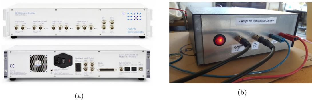
FIGURE 2.1 – Appareils utilisés pour l'excitation et l'acquisition. (a) Lock-in amplifieur Zurich Instruments HF2LI MF (image Zurich Instruments). (b) Amplificateur à transconductance (réalisation Hervé Ayroles, IMFT).
