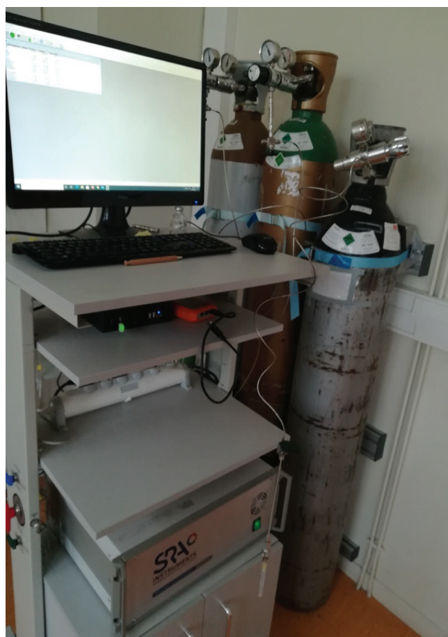
Figure III-7 photographie du SRA R3000, micro-GC utilisé durant ma thèse et présent au laboratoire de géologie de Lyon.
