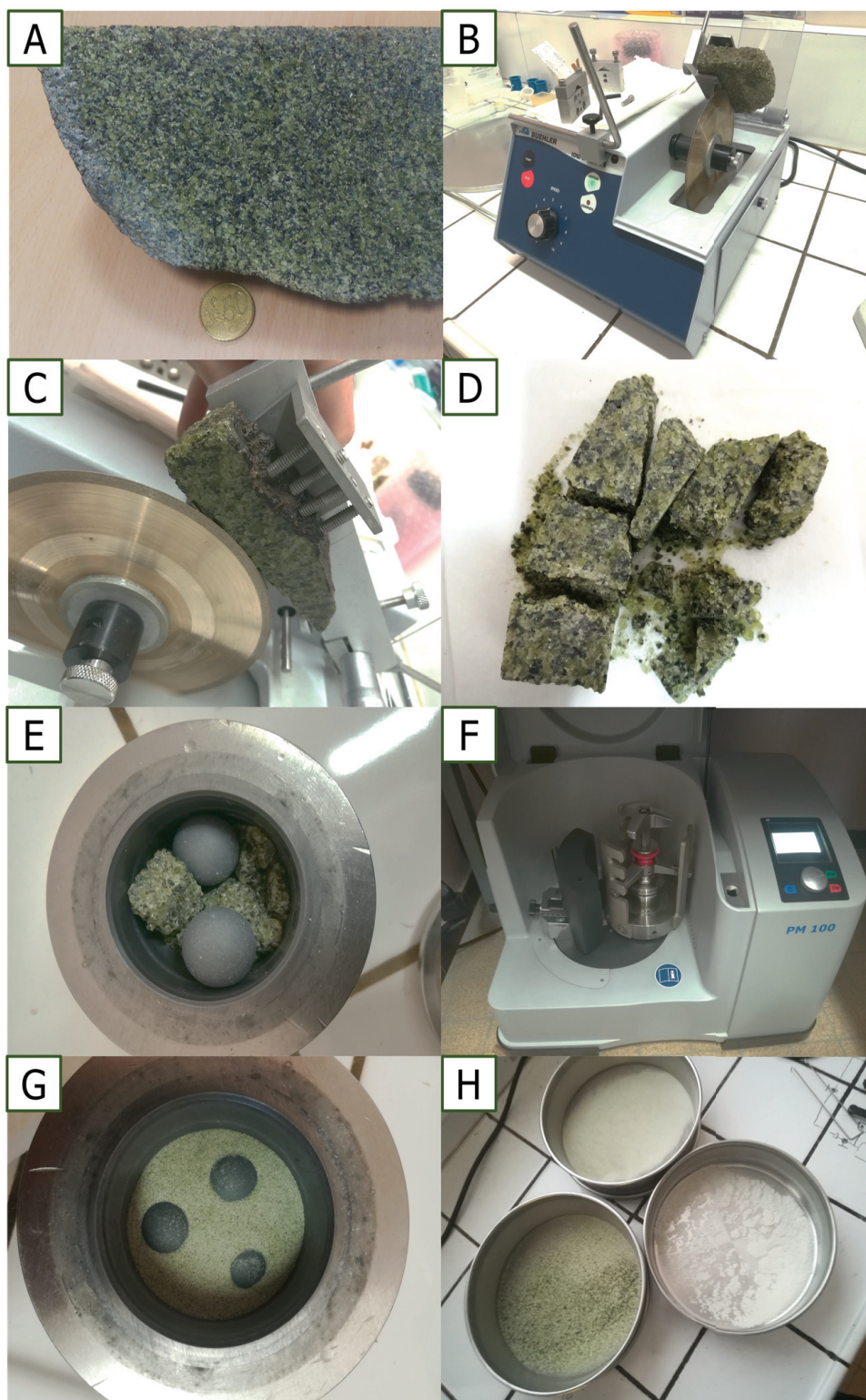
Figure III-5 Résumé des différentes étapes de préparation de la poudre de péridotite de Borée. La péridotite initiale (A) est coupée en tranches (B), les parties extérieures sont coupées pour supprimer les parties oxydées et les impuretés (B-C). La partie interne de la péridotite est coupée en tranches et petits blocs (C). Les blocs sont ensuite brisés avec un marteau (D), puis placés dans le bol en carbure de tungstène du broyeur avec 2 billes (E). Le bol dans le broyeur planétaire réalise plusieurs séries de broyage de 3 à 4 min à 390 TPM (F). La poudre obtenue (G) est tamisée avec des tamis de 150 et 40 microns (H). L'ensemble de la section est broyé afin d'avoir toute la poudre à la taille de grain souhaité.
