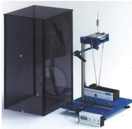
Figure V-3: Pendule de Persoz utilisé pour les mesures de dureté
