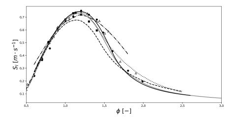
**Figure 5.1:** Comparison of ethylene laminar flame speed for different mechanisms (Bisetti et al. [231] : (---), Blanquart et al. [271] : (---), Slavinskaya et al. [272] : (---), KM2 [94] : (---), POLIMI [275] : (----), Hassan et al. [276] : ( $\blacksquare$ ), Egolfopoulos et al. [277] : ( $\triangle$ ), Jomaas et al. [278] :( $\bullet$ )
