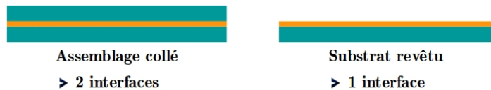
FIGURE 1.1 – Similitude entre un assemblage collé et un substrat revêtu.
