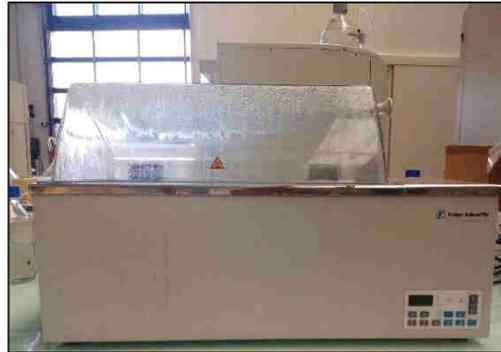
**Figure 4.2** Bain marie utilisé pour les expériences d'hydrolysabilité
