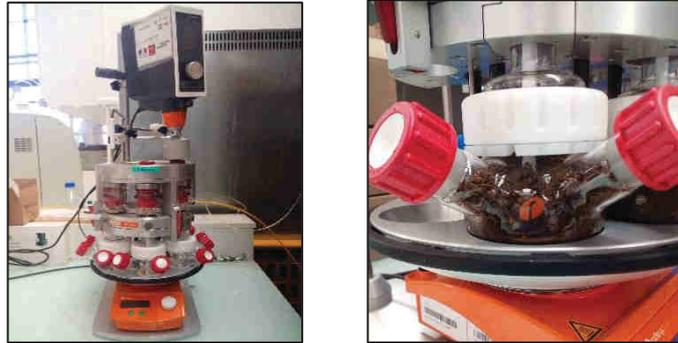
**Figure 4.4** Système Tornado employé pour des hydrolyses à haute consistance d'extrudats et bioextrudats
