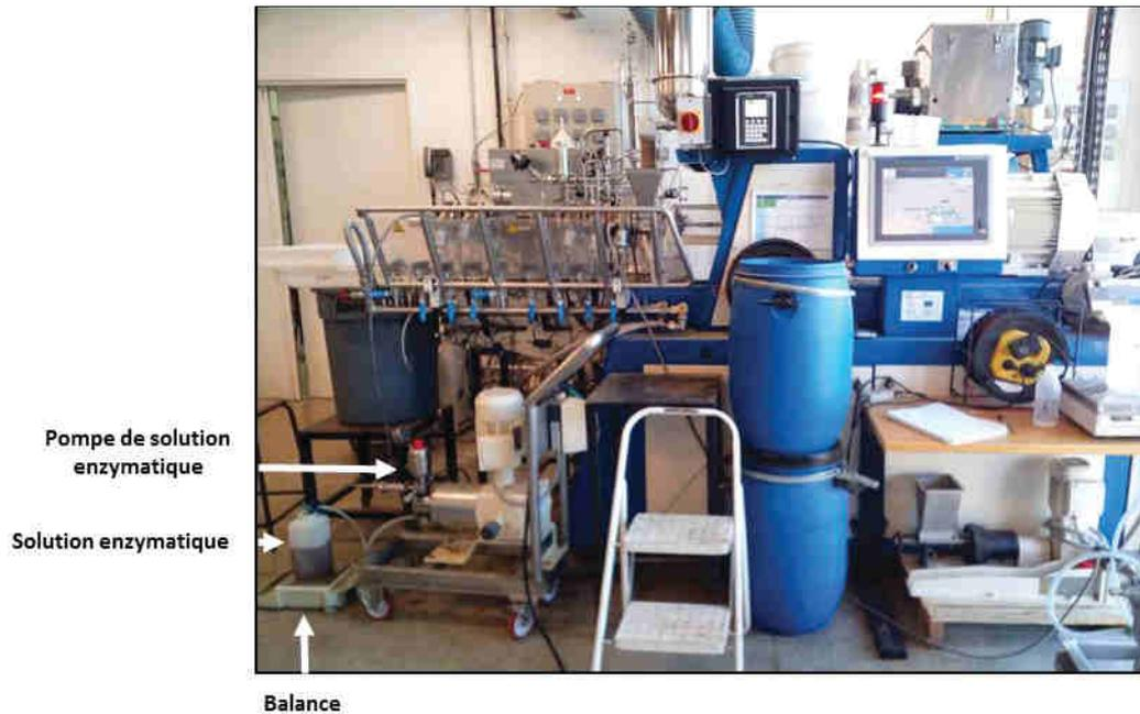
**Figure 3.2** Photo de l'extrudeur EV 25 lors des expériences de bioextrusion
