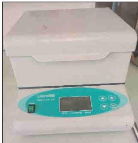
**Figure 4.3** Incubateur utilisé pour expériences d'hydrolyse à haute consistance
