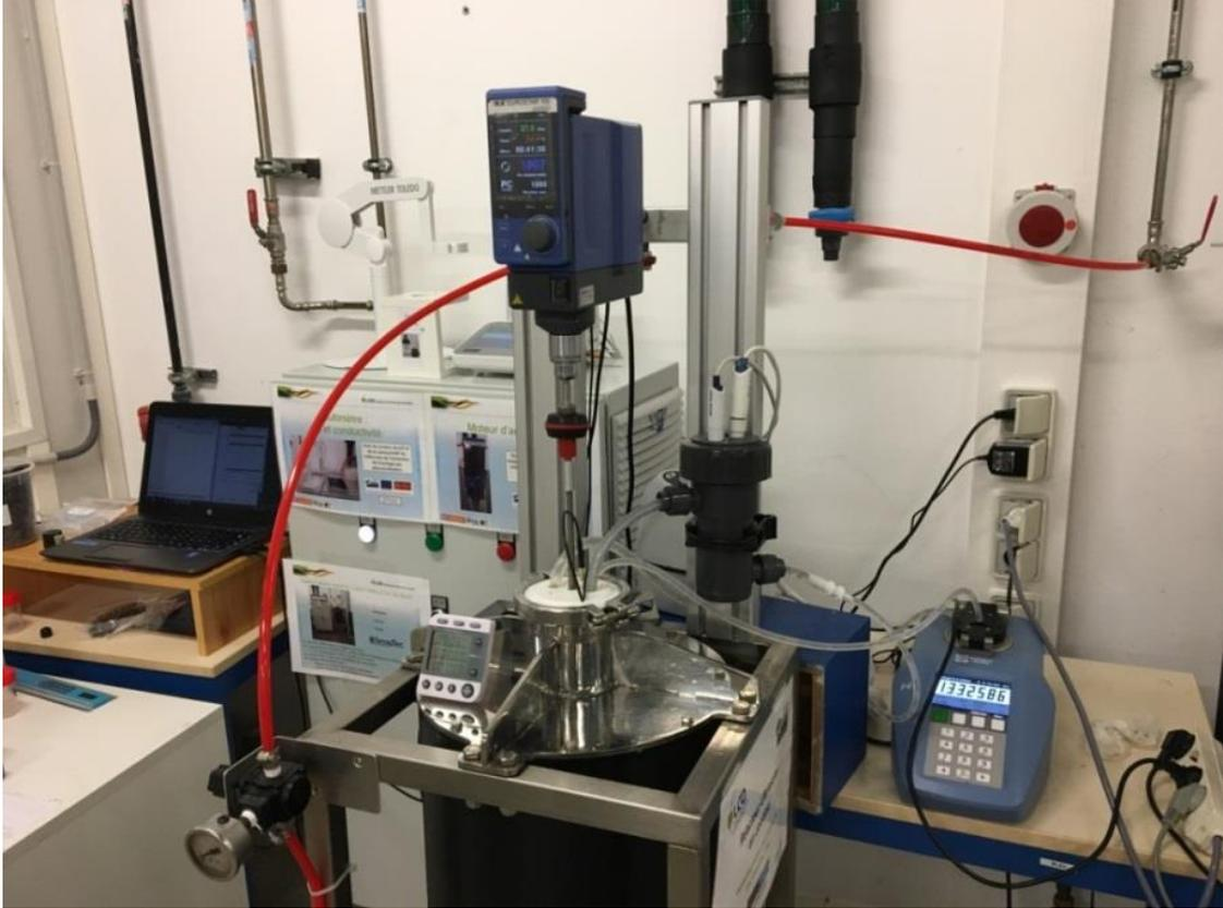
**Figure 2-2.** Montage de la colonne à ultrasons en mode batch avec la circulation du liquide au sein des différents instruments de mesure.
