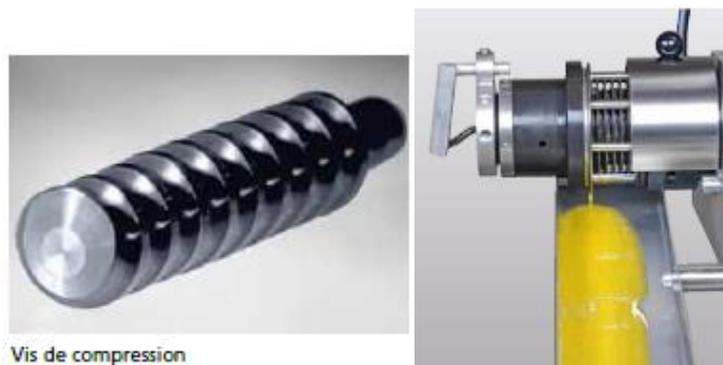
Figure 2-11. Illustration de la vis de compression et du cylindre d'extraction avec la zone de libération d'huile (images provenant du site du constructeur).
