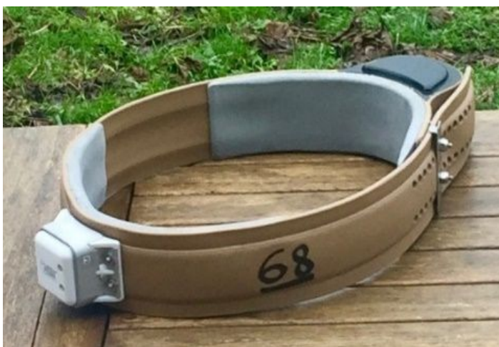
Photographie 1 : Collier GPS Lotek Litetrack Iridium 750 PB
