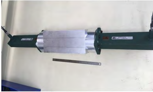
Figures 3.36 – Mesures de la propagation du mode TE_{11} dans les guides a) cylindrique et b) corrugué.
