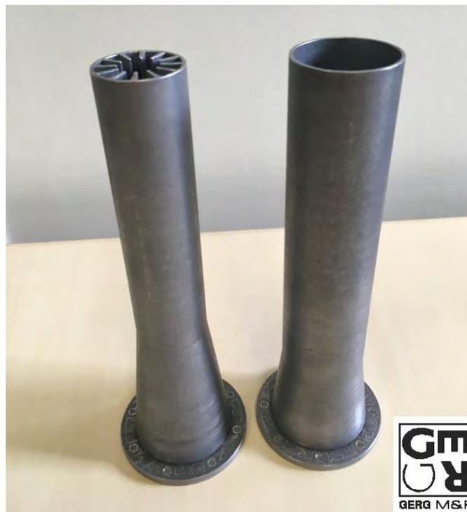
Figure 4.34 – Sondes corruguée et métallique.
