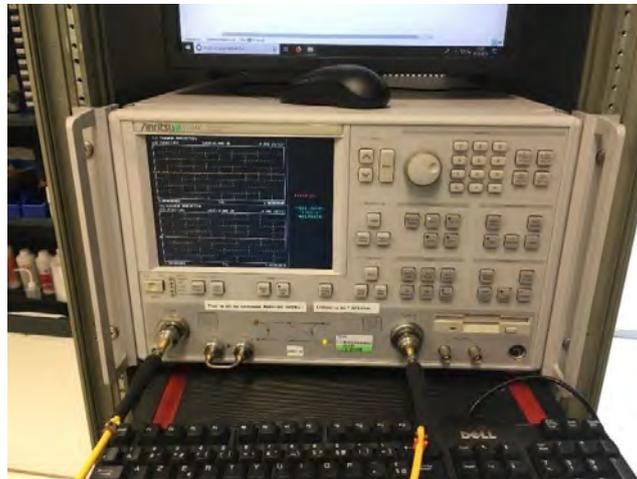
Figure 3.32 – Analyseur de réseau vectoriel Anritsu 37369C.
