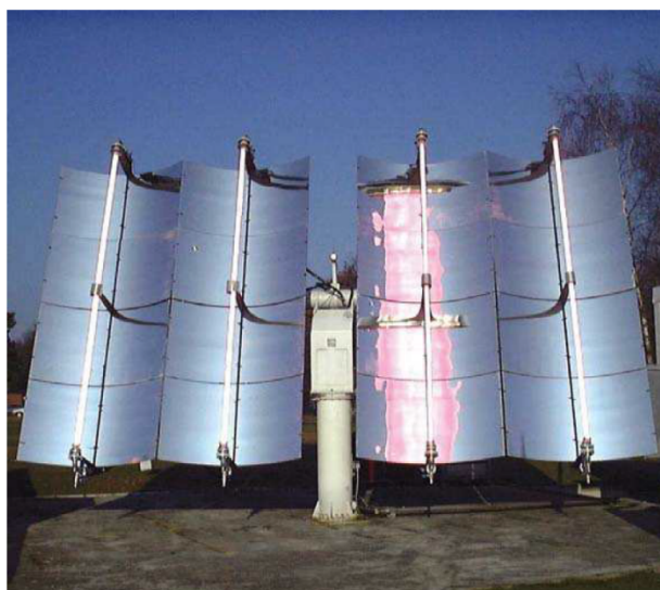
Figure 1.4. Photoréacteurs munis de réflecteurs paraboliques de la Deutsche Zentrum für Luft- und Raumfahrt (extrait de [104]).
