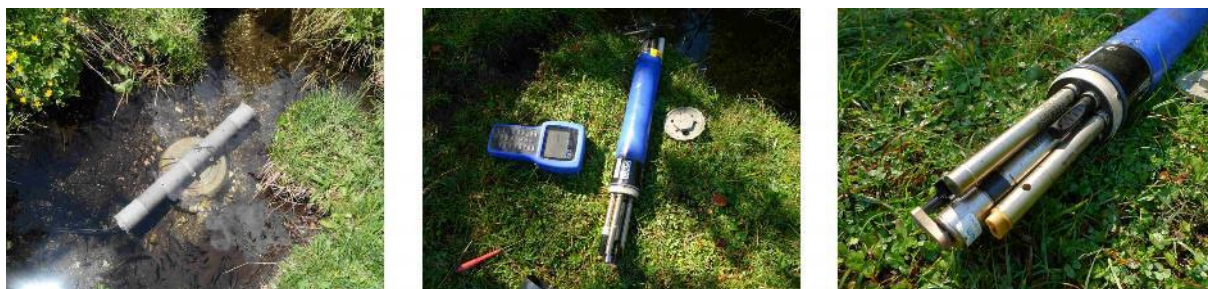
Figure 14 Sonde multi-paramètres de mesure hydrologiques et biogéochimiques à haute fréquence (© L. Boithias)
