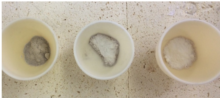
Figure 80 Calcination de la poudre \text{Ag}_{20}\text{-P1} à 850°C pour un temps de : 30 s, 1 min et 1 min 30 (gauche à droite)
