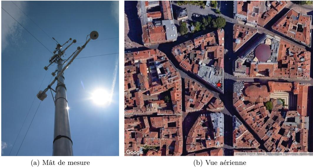
FIGURE 4.2 – (a) Mât de mesure utilisé pendant la campagne CAPITOUL pour recueillir des données à une vingtaine de mètres au-dessus des toits. Le mât est fixé sur le toit d'un bâtiment de 20,5 m de hauteur. Crédits : CNRM. (b) Vue aérienne du site de mesure. L'étoile indique l'emplacement du mât de mesure.
