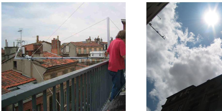
FIGURE 4.18 – Photographies des perches de mesures des flux de CO<sub>2</sub> et de chaleur utilisés pendant la campagne CAPITOUL. Crédits : CNRM.
