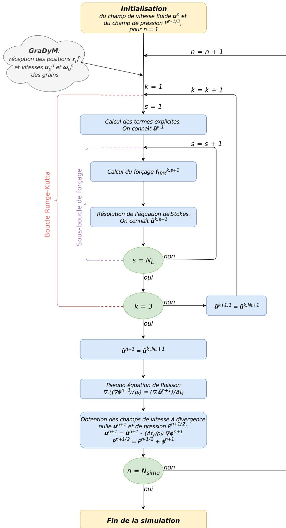
**FIGURE 2.5** – Représentation schématique de l’algorithme de résolution de Jadim (inspiré de CHOUÏPPE (2012)).  $N_L$  est le nombre de passage par la sous-boucle de forçage et  $N_{simu}$  le nombre total de pas de temps que l’on souhaite réaliser.
