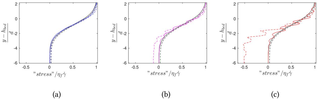
**FIGURE G.1** – Contrainte de cisaillement apparente dans la phase fluide  $\Sigma_{xy}^f$  pour (a) :  $h_g = d/2$ ; (b) :  $h_g = d/4$ ; (c)  $h_g = d/10$ . L'intégrale  $\int \frac{1}{\epsilon} (\epsilon \rho_f \langle u_y \rangle^f \frac{\partial \langle u_y \rangle^f}{\partial y} + n \langle f_1 \rangle_y^p) dy'$  est aussi représentée en pointillés. Sur chaque graphe, le cas de référence pour  $h_g = d$  est aussi tracé.
