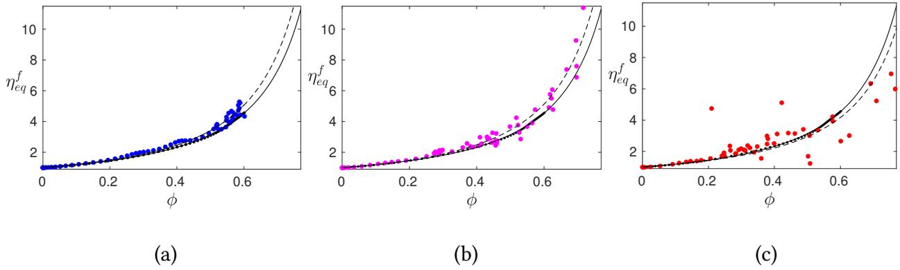
**FIGURE 5.17** – (●, ●, ●) Viscosité apparente de la phase fluides  $\eta_{eq}^f$  pour (a) :  $h_g = d/2$ ; (b),  $h_g = d/4$ ; (c) :  $h_g = d/10$ . Sur chaque graphe, la viscosité apparente obtenue pour  $h_g = d$  est aussi tracée en noir (●). On a également tracé le meilleur ajustement (par la relation (5.49)) sur chaque graphe, pour  $h_g = d$  en trait plein ( $\beta = 1.65$ ) et pour (a) :  $\beta = 1.768$ ; (b) :  $\beta = 1.783$ ; (c) :  $\beta = 1.558$ , en pointillés.
