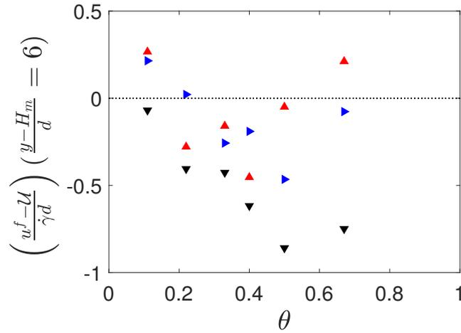
**FIGURE 5.28** – Écart de entre les vitesses microscopique  $u^f$  et macroscopique  $U$ , adimensionné par  $\dot{\gamma}d$ , en fonction du nombre de Shields  $\theta$  pour (▼) :  $Re_p = 0.1$ ; (►) :  $Re_p = 1$ ; (▲) :  $Re_p = 10$ .
