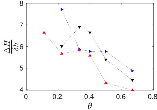
**FIGURE E.1** – Rapport  $\frac{\Delta H}{\delta h}$  en fonction du nombre de Shields  $\theta$  pour les nombres de Reynolds ( $\blacktriangledown$ ):  $Re_p = 0.1$ ; ( $\blacktriangleright$ ):  $Re_p = 1$ ; ( $\blacktriangle$ ):  $Re_p = 10$ .
