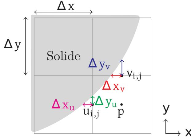
**FIGURE 2.4** – Représentation schématique d'une cellule de calcul à l'extérieur du grain pour laquelle  $\alpha \neq 0$ . Les notations des distances sont mises en évidence pour faire le lien avec le schéma d'interpolation 2D (équations (2.23) et (2.24)).
