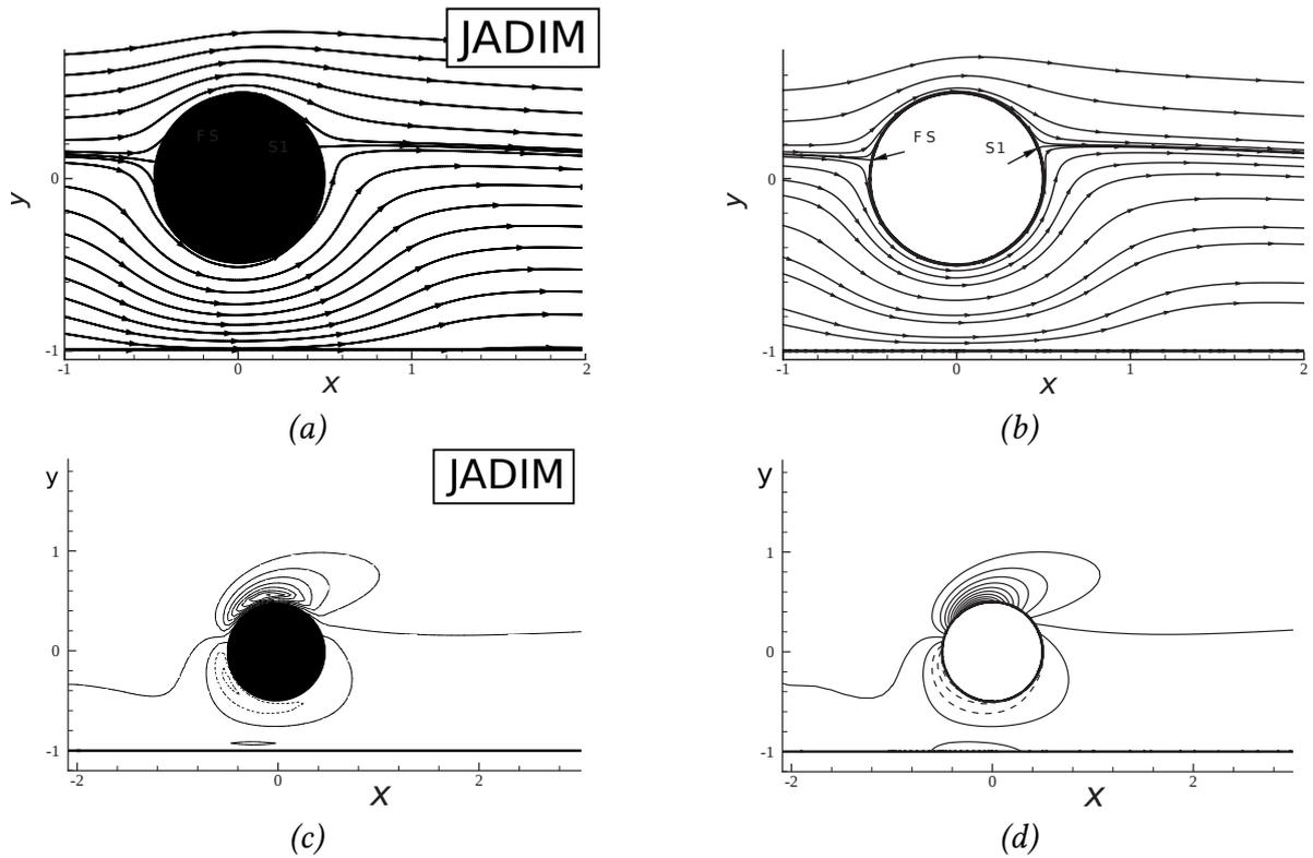
**FIGURE 2.15** – Lignes de courant dans le plan  $z = 0$  obtenues : (a) : via la présente méthode; (b) par ZENG et al. (2009). Lignes d'iso-vorticité dans le plan  $z = 0$  obtenues via : (c) : la présente méthode; (d) : par ZENG et al. (2009) ( $Re = 10$  et  $L = 1$ ).
