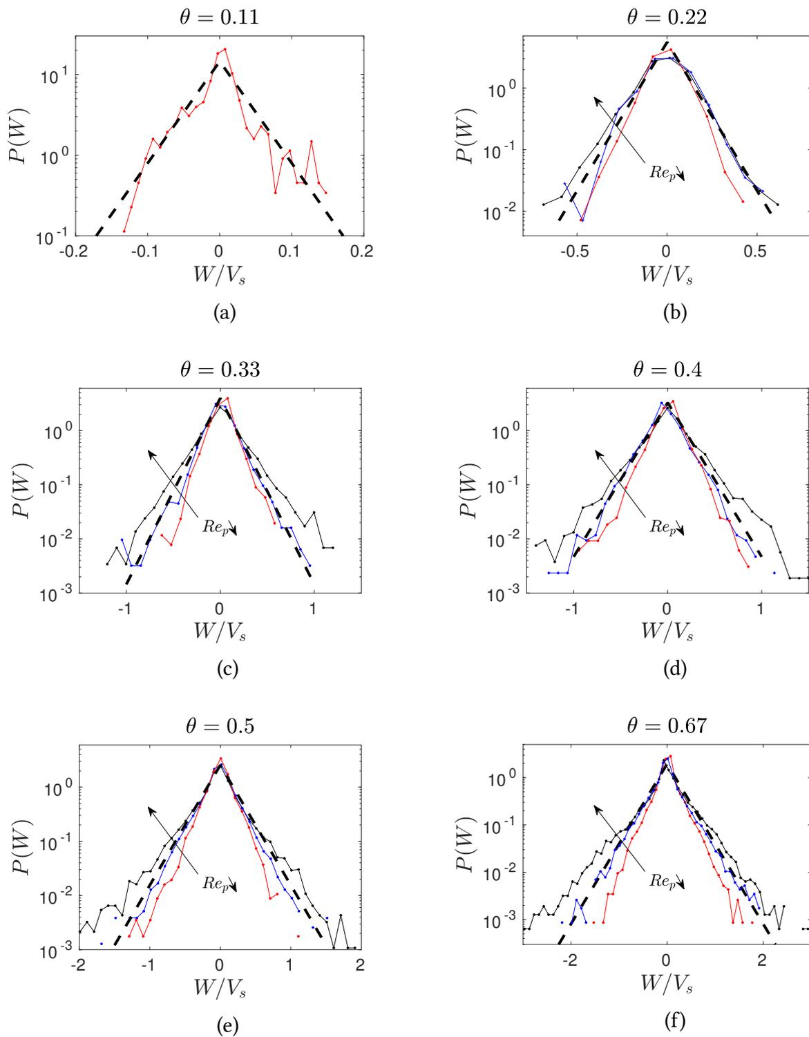
**FIGURE 4.21** – Distribution des vitesses transversales des grains avec les mêmes notations que pour la figure 4.17. Les ajustements représentés (en pointillés noirs) ne prennent en compte que le nombre de Reynolds de  $Re_p = 1$  afin de ne pas surcharger les graphes et sont effectués à l'aide de la loi de probabilité (4.32).
