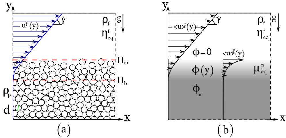
**FIGURE 5.1** – Schéma représentant le problème d'un écoulement granulaire cisailé à l'échelle microscopique (a) et à l'échelle mésoscopique (b).
