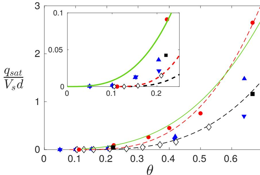
**FIGURE 4.34** – Débit granulaire adimensionné par  $V_s d$  en fonction du nombre de Shields  $\theta$  pour  $Re_p = 1$ . (■) : présente méthode AVEC le modèle de lubrification ; (●) : présente méthode SANS le modèle de lubrification. La fin de la légende est la même que pour la figure 4.4 (b).
