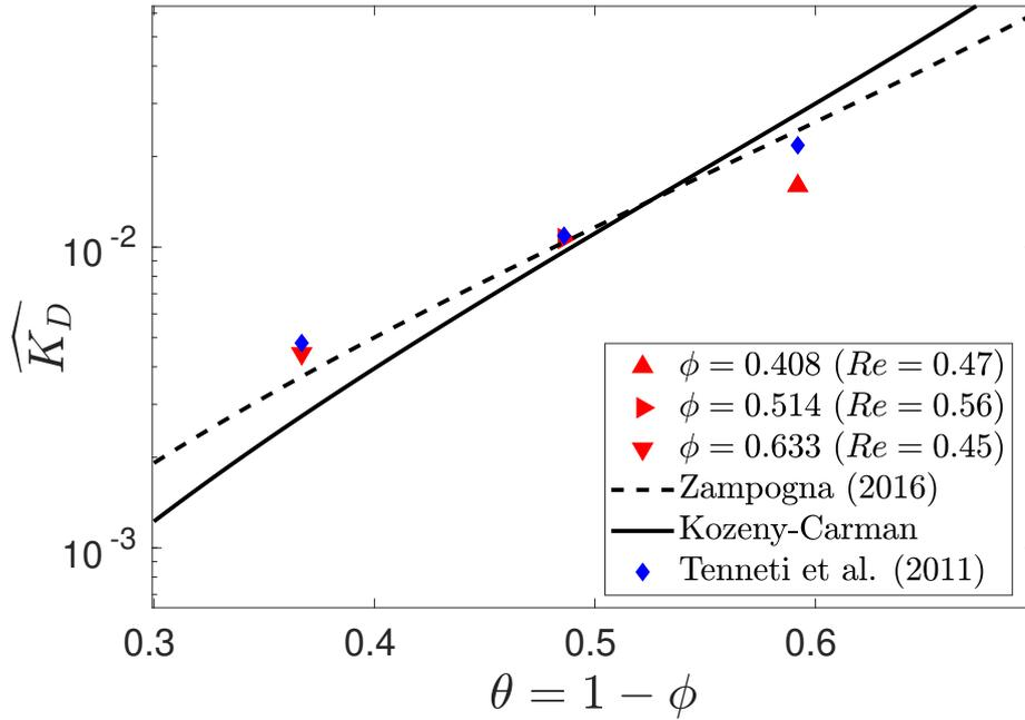
**FIGURE 2.29** – Comparaison avec la relation de Kozeny-Carman : perméabilités apparentes normalisées (par  $R^2/\eta_f$ ) du milieu poreux en fonction de la porosité; avec  $d/\Delta x \simeq 50$ . Ces valeurs sont obtenues avec  $Re \simeq 0.5$
