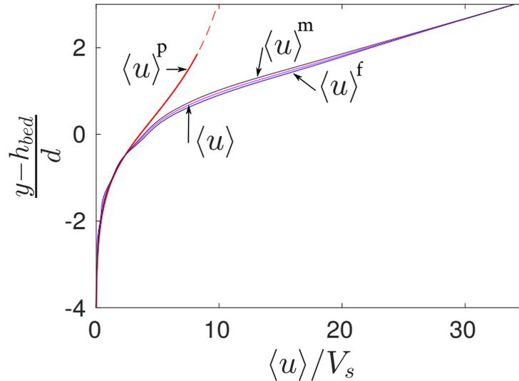
**FIGURE 5.4** – Profils verticaux des vitesses (rouge -) : granulaire  $\langle u \rangle^p$ , (bleu -) : fluide  $\langle u \rangle^f$ , (magenta -) : de mélange  $\langle u \rangle$  et (noir -) : de la phase de mélange  $\langle u \rangle^m$  pour  $Re_p = 1$ ,  $\theta = 0.67$ ,  $r = 1$  et  $h_g = d$ .
