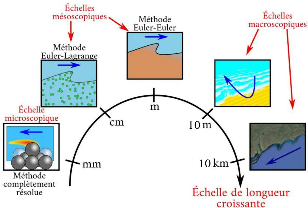
**FIGURE 1.6** – Schéma des différentes échelles de description (inspiré de D'ALBIGNAC (2012)).
