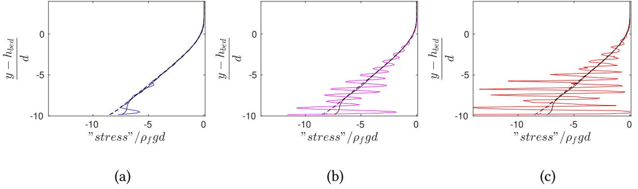
**FIGURE G.2** – Contrainte normale apparente dans la phase granulaire  $\Sigma_{yy}^p$  pour (a) :  $h_g = d/2$ ; (b) :  $h_g = d/4$ ; (c)  $h_g = d/10$ . L'intégrale  $\int (\phi \rho_p \langle u_y \rangle^p \frac{\partial \langle u_y \rangle^p}{\partial y} - \phi \frac{\partial \Sigma_{yy}^f}{\partial y} - n \langle f_1 \rangle_y^p - \rho_p \phi g_y) dy'$  est aussi représentée en pointillés. Sur chaque graphe, le cas de référence pour  $h_g = d$  est aussi tracé en noir.
