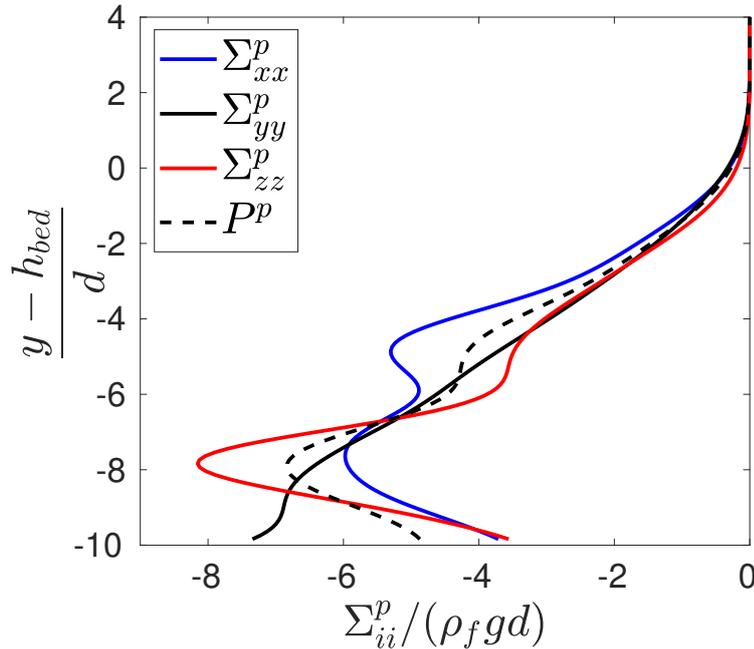
**FIGURE 5.13** – Profils verticaux de l'ensemble des composantes diagonales du tenseur des contraintes apparentes dans la phase granulaire,  $\Sigma_{ii}^p$  pour  $i = x, y, z$  (en traits pleins). (---) : Pression granulaire  $P^p$  définie par l'équation (5.35).
