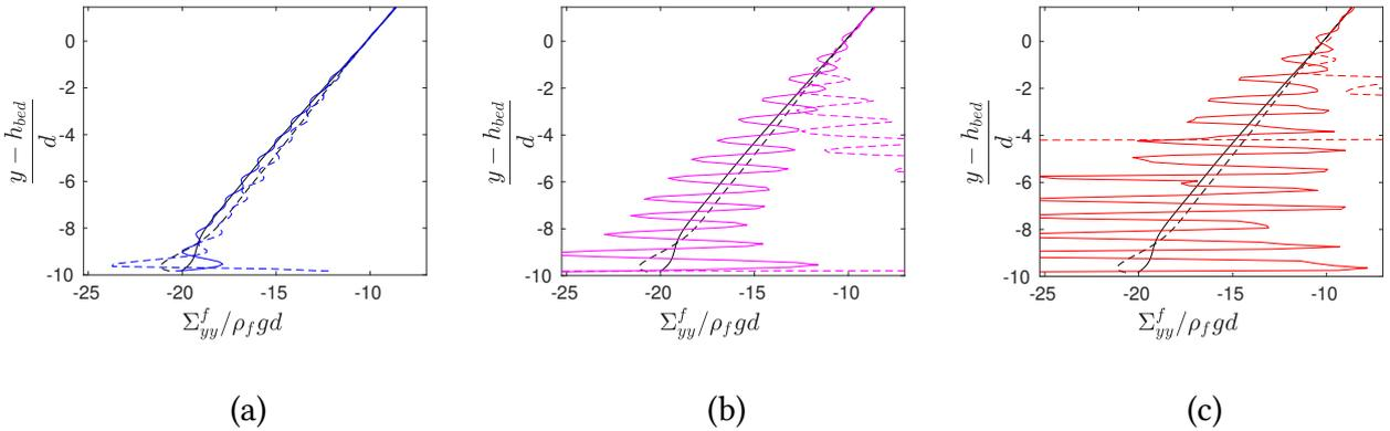
**FIGURE 5.7** – Contrainte normale apparente dans la phase fluide  $\Sigma_{yy}^f$  pour (a) :  $h_g = d/2$ ; (b) :  $h_g = d/4$ ; (c) :  $h_g = d/10$ . L'intégrale  $\int \frac{1}{\epsilon} (\epsilon \rho_f \langle u_y \rangle^f \frac{\partial \langle u_y \rangle^f}{\partial y} + n \langle f_1 \rangle_y^p - \rho_f \epsilon g_y) dy'$  est aussi représentée en pointillés. Pour chaque graphe, le cas de référence pour  $h_g = d$  est aussi tracé en noir.
