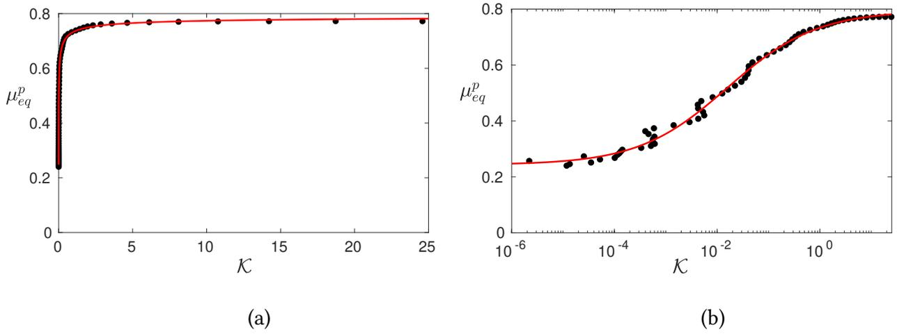
**FIGURE 5.20** – Coefficient de friction effectif de la phase granulaire  $\mu_{eq}^p$  en fonction du nombre  $\mathcal{K}$ , (a) : en échelle linéaire; (b) : en échelle semi-logarithmique. (●) : étude présente, (–) : ajustement de la relation (5.56),  $\mu_1 = 0.243$ ,  $\mu_2 = 0.794$  et  $\sqrt{K_0} = 0.125$ .
