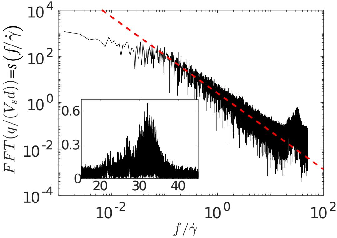
**FIGURE 3.8** – Spectre de Fourier du signal  $q(t)/(V_s d)$  pour  $\dot{\gamma}t \geq 500$  (i.e. dans le régime permanent) pour  $Re_p = 1$ ,  $\theta = 0.67$  et  $r = 2.5$ . (--) : loi de puissance  $s(f/\dot{\gamma}) \sim (f/\dot{\gamma})^{-1.55}$ .
