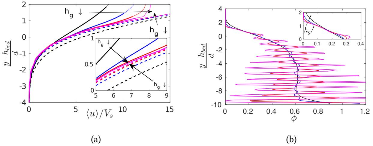
**FIGURE 5.3** – (a) : Profils verticaux des vitesses moyennes des phases fluide (pointillés) et granulaire (traits pleins), (noir –) pour  $h_g/d = 1$ ; (bleu –) pour  $h_g/d = 1/2$ ; (rouge –) pour  $h_g/d = 1/4$ ; (magenta –) pour  $h_g/d = 1/10$ . (b) : Profil vertical de fraction volumique solide  $\phi$  pour les mêmes valeurs de  $h_g$  et avec le même code couleur. La vitesse de la phase granulaire est tracé en trait épais pour  $\phi \leq 0.025$  et en trait fin sinon.
