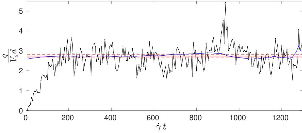
**FIGURE 3.10** – Débit granulaire adimensionné par  $V_s d$  en fonction du temps adimensionné  $\dot{\gamma}t$ . (–) : débit instantané  $q(t)/V_s d$ ; (—) : fonction  $q_{conv}(t)/V_s d$ ; (—) : débit saturé  $q_{sat}/V_s d$ ; (---) : bornes de l'intervalle de confiance à 95% pour  $q_{sat}^\dagger/V_s d$ .
