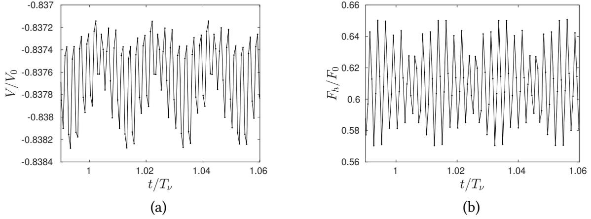
**FIGURE 2.12** – (a) : Oscillations de la vitesse de sédimentation  $V$  de la sphère et (b) : Oscillations de la force hydrodynamique  $F_h$  exercée par le fluide sur la sphère ( $Re = 41$ ,  $d/\Delta x = 10$  et  $\Delta/\Delta x = 1.3$ ). La force hydrodynamique est adimensionnée par avec  $F_0 = \rho_p V_p g$ .
