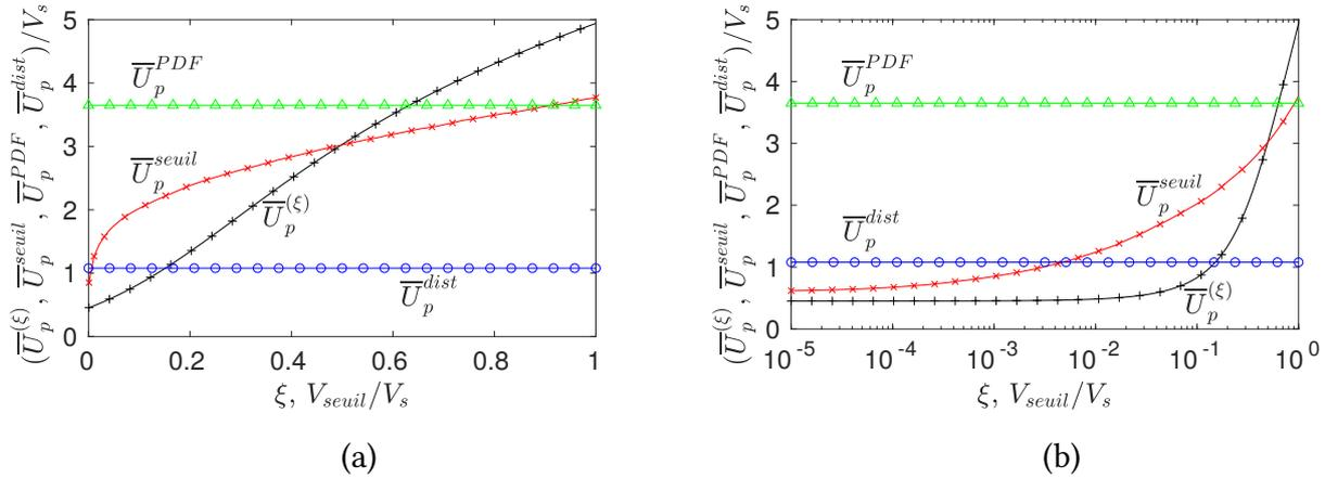
**FIGURE 4.29** – Valeurs de la vitesse moyenne de la couche de grains mobiles (adimensionnée par la vitesse de Stokes) pour les différentes définitions ( $Re_p = 1$ ,  $\theta = 0.67$  et  $r = 2.5$ ).
