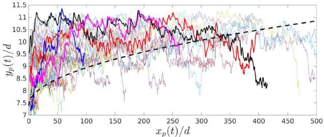
**FIGURE 4.28** – Trajectoires  $(x_p(t), y_p(t))$  pour l'ensemble des particules. Certaines trajectoires sont en gras afin de mettre en évidence le mélange entre les différentes altitudes du lit de grains. La courbe en pointillés correspond au profil de vitesse parabolique (équation (4.12)) multiplié par la durée de la simulation.
