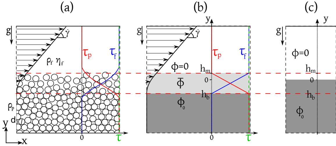
**FIGURE 4.2** – Schéma du modèle de MOULLERON et al. (2009). (a) : écoulement de cisaillement non modélisé; (b) modélisation de l'écoulement de cisaillement; (c) : état de repos du lit de grains dans le cadre de ce modèle (absence de cisaillement). La vitesse  $u$  est représentée sur la gauche des schémas et les contraintes de cisaillement ( $\tau$ ,  $\tau_p$  et  $\tau_f$ ) sur leur droite.
