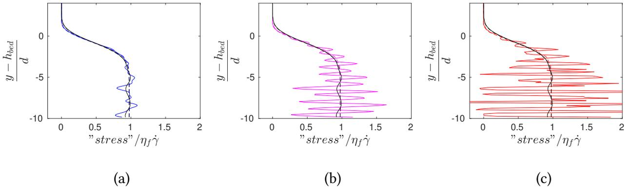
**FIGURE G.3** – Contrainte de cisaillement apparente dans la phase granulaire  $\Sigma_{xy}^p$  pour (a) :  $h_g = d/2$ ; (b) :  $h_g = d/4$ ; (c)  $h_g = d/10$ . L'intégrale  $\int (\phi \rho_p \langle u_x \rangle^p \frac{\partial \langle u_x \rangle^p}{\partial y} - \phi \frac{\partial \Sigma_{xy}^f}{\partial y} - n \langle f_1 \rangle_x^p) dy'$  est aussi représentée en pointillés. Sur chaque graphe, le cas de référence pour  $h_g = d$  est aussi tracé en noir.
