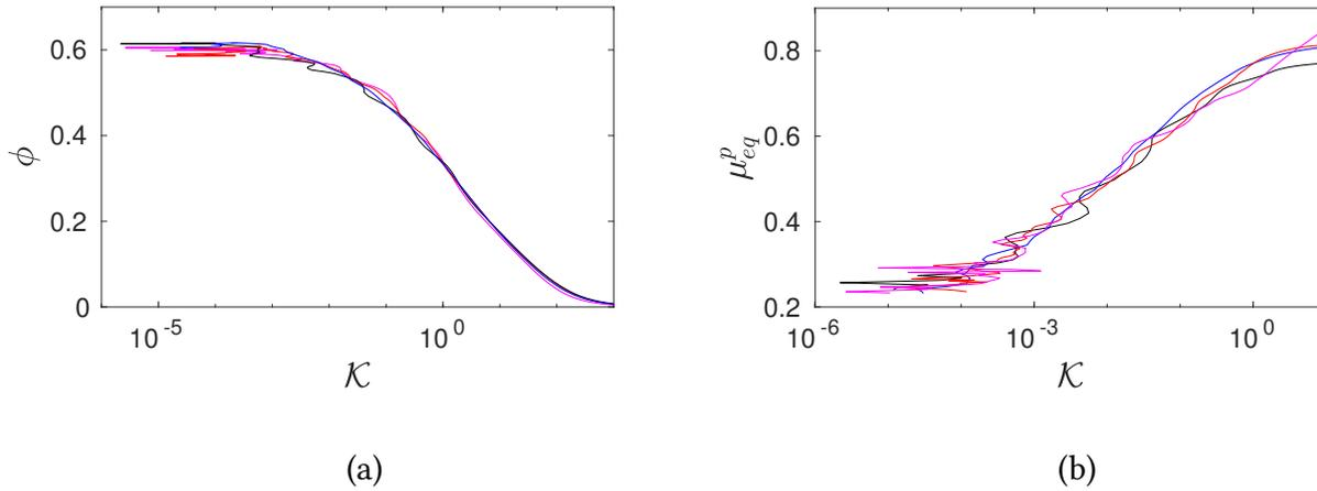
**FIGURE F.2** – (a) : Fraction volumique de grains en fonction du nombre  $\mathcal{K}$  pour les quatre cas (–) : A; (–) : B; (–) : C; (–) : D. (b) : Coefficient de friction effectif de la phase granulaire en fonction du nombre  $\mathcal{K}$  pour les quatre cas (–) : A; (–) : B; (–) : C; (–) : D (voir le tableau F.1).
