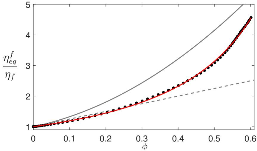
**FIGURE 5.16** – Viscosité apparente de la phase fluide  $\eta_{eq}^f$  en fonction de la fraction volumique de grains  $\phi$  pour  $Re_p = 1$  et  $\theta = 0.67$ . (●) : viscosité apparente mesurée ici; (–) : ajustement de la relation (5.49) avec  $\beta = 1.65$ ; (–) : viscosité d’EINSTEIN (relation (5.45)); (–) : viscosité de la phase fluide de GIBILARO et al. (relation (5.47)).
