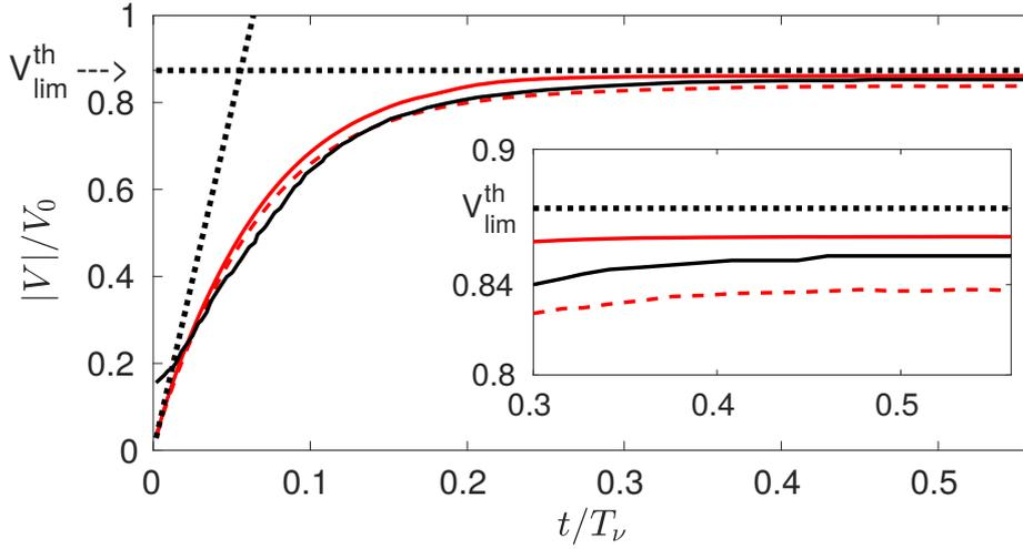
**FIGURE 2.13** – Vitesse de chute d’une sphère dans un fluide au repos ( $Re = 41$ ). La courbe noire correspond à l’expérience de MORDANT et PINTON (2000). Présente étude 3D en rouge : (– –)  $d/\Delta x = 10$ ; (–)  $d/\Delta x = 20$ ; ( $\cdots$ ) solutions théoriques aux temps courts et aux temps longs.
