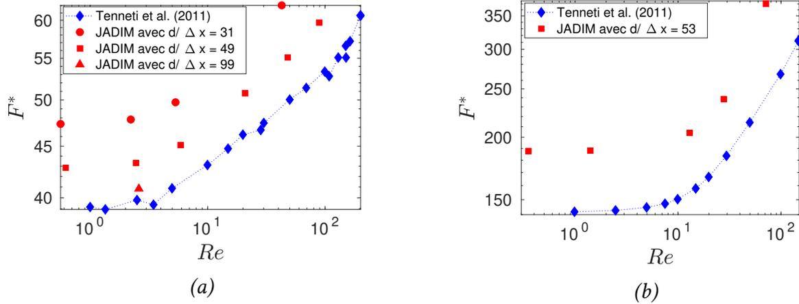
**FIGURE 2.25** – Force de traînée adimensionnée en fonction du nombre de Reynolds. (a) : pour un réseau cubique simple de fraction solide  $\phi = 0.514$  et (b) : pour un réseau cubique faces centrées avec  $\phi = 0.633$ .
