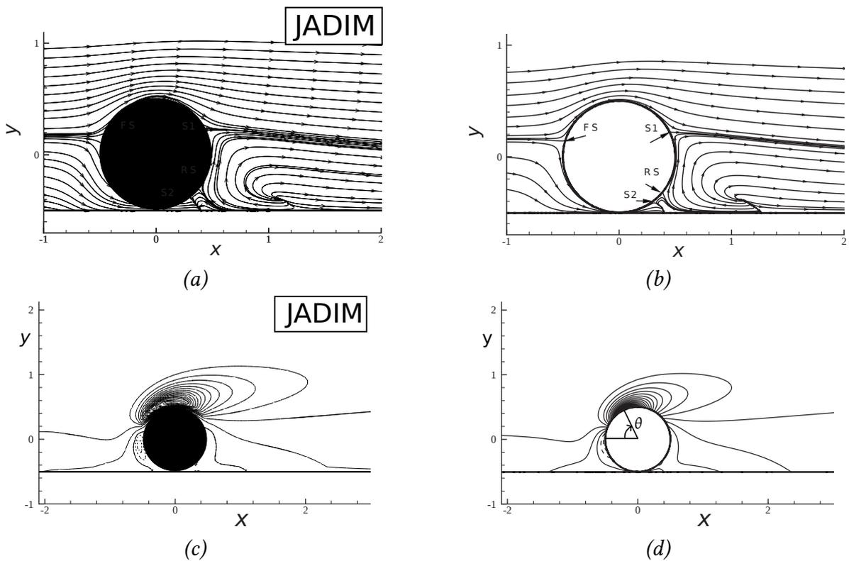
**FIGURE 2.16** – Lignes de courant dans le plan  $z = 0$  obtenues, (a) : via la présente méthode; (b) par ZENG et al. (2009). Lignes d'iso-vorticité dans le plan  $z = 0$  obtenues, (c) : via la présente méthode; (d) : par ZENG et al. (2009) ( $Re = 10$  et  $L = 0.505$ ).
