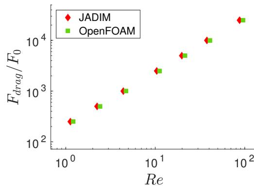
**FIGURE 2.22** – Force de traînée obtenues via JADIM et OpenFOAM en fonction du nombre Reynolds pour un réseau cubique simple de fraction solide  $\phi = 0.408$  et avec un raffinement spatial  $d/\Delta x = 46$ .
