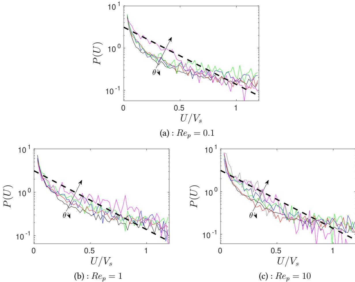
**FIGURE 4.16** – Distributions des vitesses des grains dans le sens de l'écoulement pour  $U \leq 1.2V_s$  et pour (a) :  $Re_p = 0.1$ , (b) :  $Re_p = 1$  et (c) :  $Re_p = 10$ . (noir -) :  $\theta = 0.67$ ; (bleu -) :  $\theta = 0.50$ ; (rouge -) :  $\theta = 0.40$ ; (vert -) :  $\theta = 0.33$ ; (magenta -) :  $\theta = 0.22$ ; (gris -) :  $\theta = 0.11$  (pour la figure (c) uniquement). (- -) : distribution exponentielle (équation (4.31)) pour  $\bar{U}_p = 0.32V_s$ .
