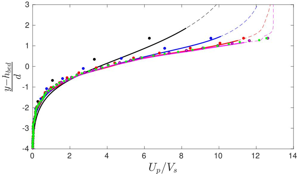
**FIGURE 5.5** – Profils verticaux de vitesse moyenne des grains, via la méthode d'homogénéisation de JACKSON (2000) (en traits plein pour  $\phi \geq 0.025$  et en pointillés sinon) et via la méthode "simple" (symboles ●) pour différentes épaisseurs caractéristiques des VER. (-●) :  $h_g/d = 1$ ,  $\Delta_h/d = 0.98$ ; (-●) :  $h_g/d = 1/2$ ,  $\Delta_h/d = 0.48$ ; (-●) :  $h_g/d = 1/4$ ,  $\Delta_h/d = 0.24$ ; (-●) :  $h_g/d = 1/10$ ,  $\Delta_h/d = 0.12$ ; (●) :  $\Delta_h/d = 0.09$ .
