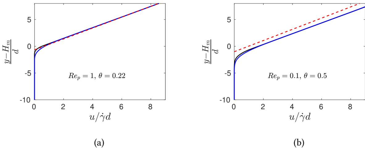
**FIGURE 5.27** – Profils verticaux de la vitesse du fluide dans le sens de l'écoulement, adimensionné par  $\dot{\gamma}d$ , (noir  $-$ ) : à l'échelle microscopique ( $u^f$ ); (bleu  $-$ ) : à l'échelle mésoscopique ( $\langle u_x \rangle^f$ ); (rouge  $- -$ ) : à l'échelle macroscopique ( $\mathcal{U}$ ). (a) :  $Re_p = 1, \theta = 0.22$  (écart minimum observé entre  $\mathcal{U}$  et  $u^f$ ); (b) :  $Re_p = 0.1, \theta = 0.5$  (écart maximum observé entre  $\mathcal{U}$  et  $u^f$ ).
