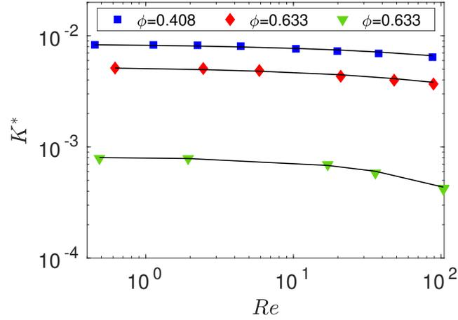
**FIGURE 2.28** – Perméabilité apparente en fonction du nombre de Reynolds pour différentes porosités et les ajustements de ces données par l'équation (2.44) (avec les coefficients  $b$  et  $n$  donnés dans le tableau 2.9).
