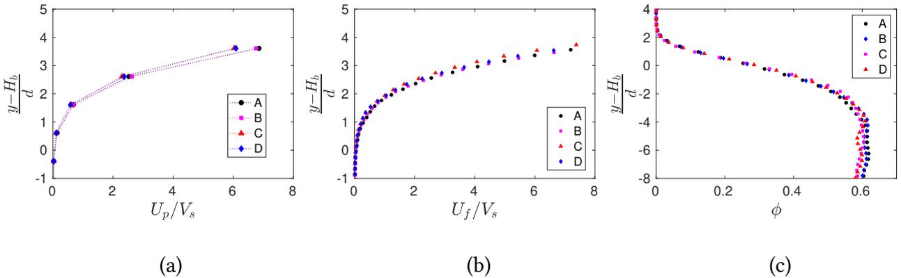
**FIGURE 3.11** – (a) : Profils verticaux de la vitesse moyenne des grains; (b) : Profils verticaux de la vitesse moyenne du fluide; (c) : Profils verticaux de fraction volumique solide moyenne  $\phi$ , pour le cas-test (●) : A; (■) : B; (▲) : C; (◆) : D.
