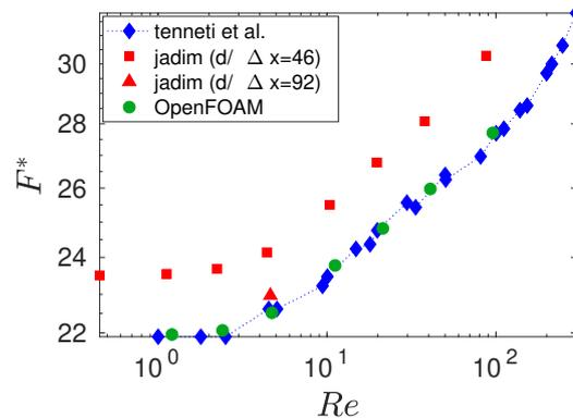
**FIGURE 2.24** – Force de traînée adimensionnée en fonction du nombre de Reynolds pour un réseau cubique simple de fraction solide  $\phi = 0.408$  obtenue par TENNETI *et al.* (2011) et via JADIM et OpenFOAM.
