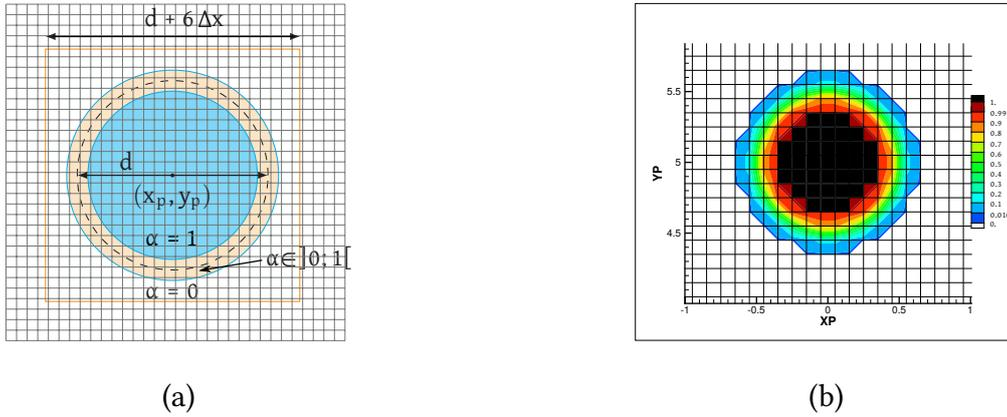
**FIGURE 2.3** – (a) : Schéma représentant la boîte sur laquelle  $\alpha$  est calculée (PIERSON (2015)).
