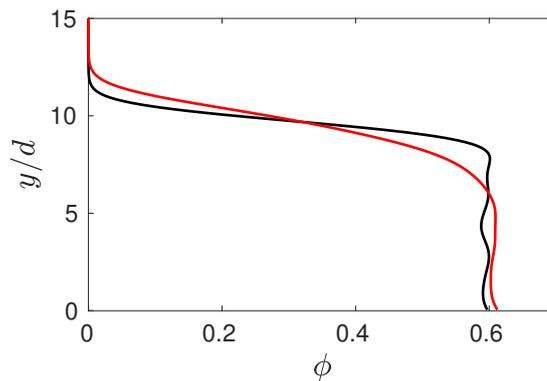
**FIGURE 4.5** – Profil vertical de fraction volumique de grains  $\phi$ . (–) :  $\phi(y, t = 0)$ ; (—) : moyenne temporelle de  $\phi(y, t)$  effectuée dans le régime permanent. La fraction volumique est calculée avec la méthode d'homogénéisation de JACKSON (2000) qui est décrite dans la section 5.1, en prenant  $h_g = d$ .
