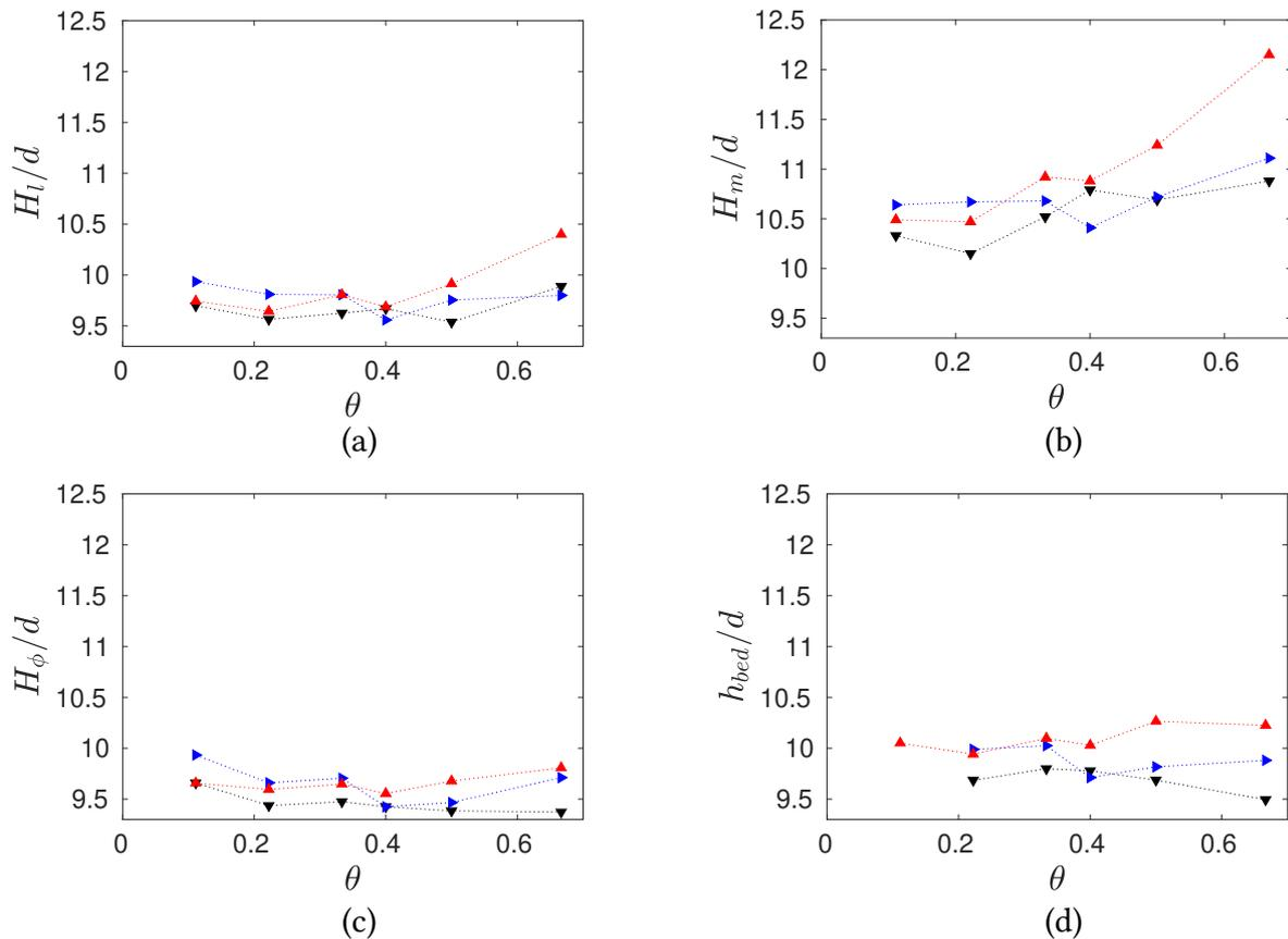
**FIGURE 4.6** – Hauteurs du lit de grains en fonction du nombre de Shields  $\theta$ , pour les nombres de Reynolds particuliers ( $\blacktriangledown$ ):  $Re_p = 0.1$ , ( $\blacktriangleright$ ):  $Re_p = 1$  et ( $\blacktriangle$ ):  $Re_p = 10$ . (a) :  $H_l$ ; (b) :  $H_m$ ; (c) :  $H_\phi$ ; (d) :  $h_{bed}$ .
