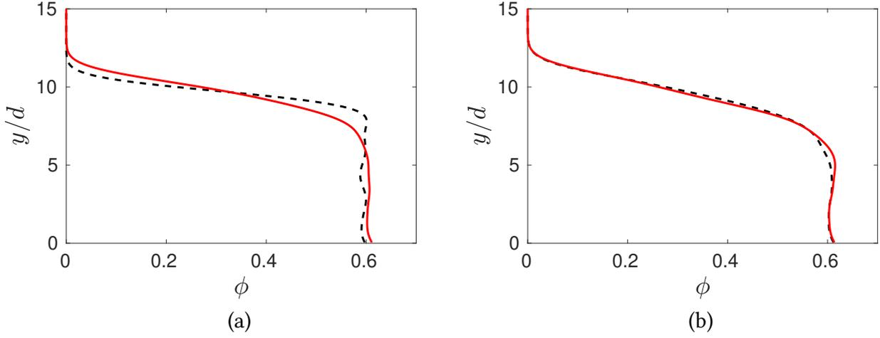
**FIGURE 3.7** – Profils de fraction volumique solide  $\phi$ . (a) : à  $\dot{\gamma}t = 0$  en pointillés noir (- -) et à  $\dot{\gamma}t = 500$  en rouge (-) (soit la fin du régime transitoire pour  $H_b(t)$ ); (b) : à  $\dot{\gamma}t = 880$  (instant  $T_1$ ) en pointillés noir (- -) et à  $\dot{\gamma}t = 990$  (instant  $T_3$ ) en rouge (-). La fraction volumique est calculée avec la méthode d’homogénéisation décrite dans la section 5.1, avec  $h_g = d$ .
