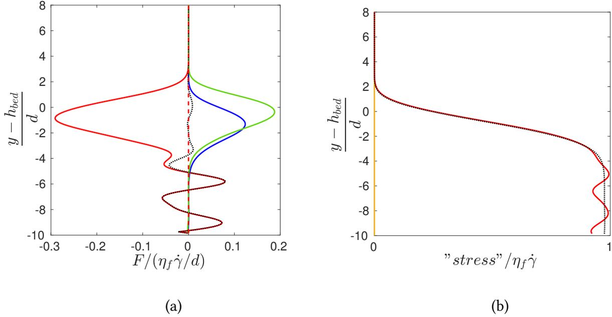
**FIGURE 5.10** – (a) : Forces moyennes appliquées à la phase équivalente granulaire dans le sens de l'écoulement. (vert –) : traînée moyenne des grains; (bleu –) : poussée d'Archimède généralisée; (rouge –) : divergence de la contrainte de cisaillement apparente dans la phase granulaire  $\Sigma_{xy}^p$ ; (rouge - -) : terme inertiel. (noir ···) : erreur (somme de tous les termes de l'équation (5.30)).
