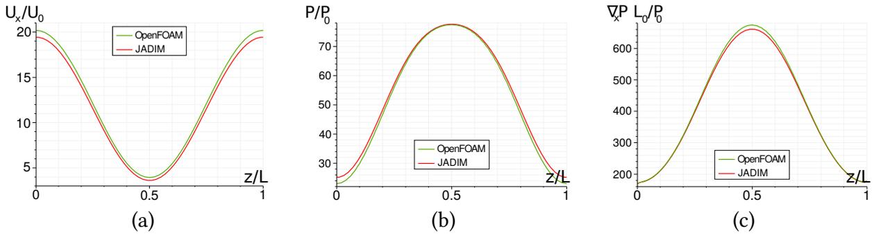
**FIGURE 2.18** – Profils de vitesse longitudinale (a), pression (b) et gradient de pression longitudinal (c) le long de l'axe 1 pour  $\phi = 0.065$ ,  $Re = 9.1$  et avec  $d/\Delta x = 25$  dans un réseau cubique simple. On compare les vitesses, pression et gradient de pression obtenus via OpenFOAM (en vert) et via notre méthode IBM (en rouge).
