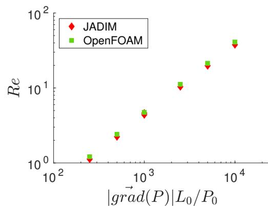
**FIGURE 2.23** – Nombre de Reynolds obtenus via JADIM et OpenFOAM en fonction du gradient de pression imposé dans un réseau cubique simple de fraction solide  $\phi = 0.408$  et avec un raffinement spatial  $d/\Delta x = 46$ .
