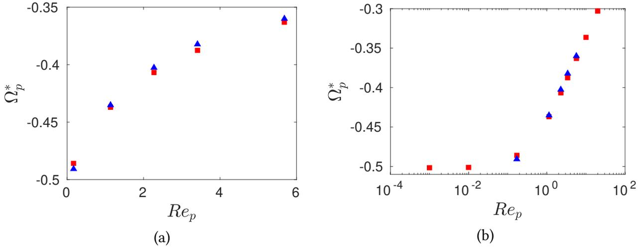
**FIGURE 2.10** – Vitesse de rotation stationnaire du cylindre  $\Omega$  (adimensionnée par  $\dot{\gamma}$ ) en fonction du nombre de Reynolds (a) échelle linéaire; (b) échelle logarithmique.
