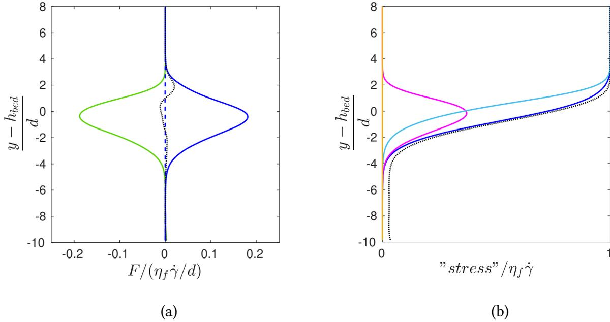
**FIGURE 5.8** – (a) : Forces moyennes appliquées à la phase équivalente fluide dans le sens de l'écoulement. (vert –) : trainée des grains (avec un signe -); (bleu –) : divergence de la contrainte de cisaillement apparente (multipliée par  $\epsilon$  pour prendre en compte la poussée d'Archimède généralisée); (bleu - -) : terme inertiel; (noir  $\dots$ ) : erreur (somme de tous les termes de l'équation (5.30)).
