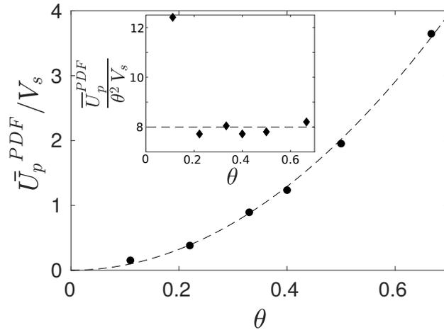
**FIGURE 4.18** – Vitesse moyenne des particules mobiles  $\bar{U}_p^{PDF}$ , adimensionnée par la vitesse de Stokes, en fonction du nombre de Shields  $\theta$ . Ces vitesses sont obtenues à partir des ajustements visibles sur la figure 4.17. (-) : ajustement d'équation  $\bar{U}_p^{PDF}/V_s = 8.0\theta^2$ . Insert :  $\bar{U}_p^{PDF}/(\theta^2 V_s)$  en fonction de  $\theta$ .
