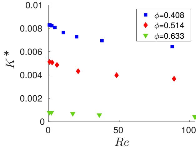
**FIGURE 2.27** – Perméabilité apparente  $K^*$  du milieu poreux en fonction du nombre de Reynolds pour  $\phi = 0.408$  et  $0.514$  pour des réseaux cubiques simples et  $\phi = 0.633$  pour un réseau cubique faces centrées ( $d/\Delta x \simeq 50$ ).  $K$  est adimensionné par  $L^2/\eta_f$ .
