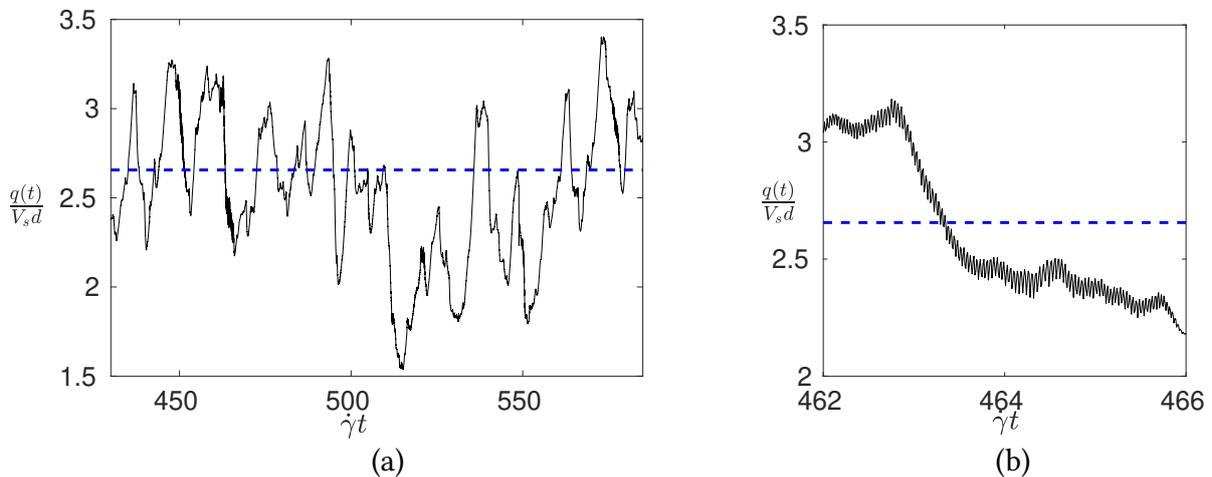
**FIGURE 3.3** – Débit granulaire en fonction du temps pour  $Re_p = 1$ ,  $\theta = 0.67$  et  $r = 2.5$ . (a) : pour  $\dot{\gamma}t \in [430; 585]$  et (b) : pour  $\dot{\gamma}t \in [462; 466]$ . Ces zooms consécutifs de la figure 3.3 permettent de mettre en évidence les différentes échelles temporelles de variations du débit de grains. (–) : débit granulaire saturé.
