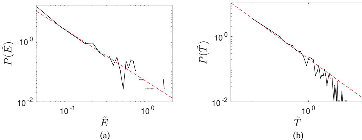
**FIGURE 3.9** – Distributions de probabilité (a) : de taille  $\tilde{E}$  et (b) : de durée  $\tilde{T}$  des fluctuations du débit de grains pour  $\dot{\gamma}t \geq 500$ ,  $Re_p = 1$ ,  $\theta = 0.67$  et  $r = 2.5$ .
