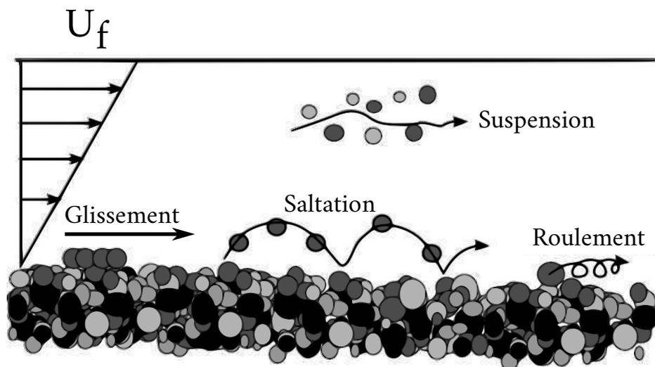
**FIGURE 1.3** – Schéma des modes de transport de grains (image tirée de BOUTELOUP (2017)).
