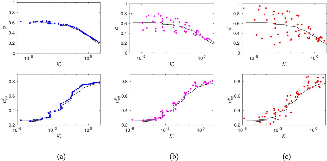
**FIGURE 5.21** – Fraction volumique de grains  $\phi$  (première ligne) et coefficient de friction effectif de la phase granulaire  $\mu_{eq}^p$  (seconde ligne) en fonction du nombre  $\mathcal{K}$ , en échelle semi-logarithmique, pour (a) :  $h_g = d/2$ ; (b) :  $h_g = d/4$ ; (c) :  $h_g = d/10$ . On a aussi tracé en noir, sur chaque graphe, le cas  $h_g = d$  comme référence.
