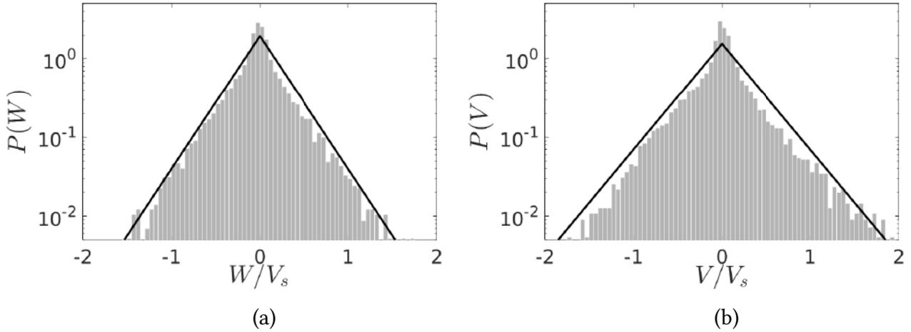
**FIGURE 4.20** – Distribution de probabilité des vitesses des particules (a) dans la direction transverse, (b) dans la direction verticale.  $Re_p = 1$ ,  $\theta = 0.67$  et  $r = 2.5$ . Les droites indiquent des distributions exponentielles (équations (4.32) et (4.33)).
