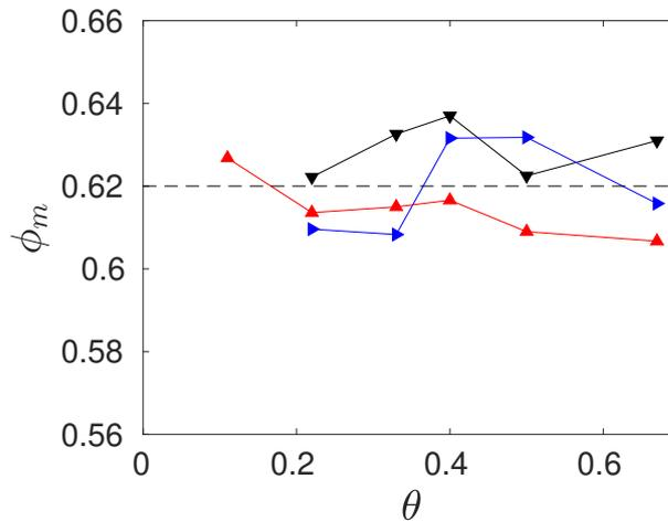
**FIGURE 5.24** – Fraction volumique de blocage  $\phi_m$  (relation (5.60)) en fonction du nombre de Shields  $\theta$  pour ( $\blacktriangledown$ ):  $Re_p = 0.1$ ; ( $\blacktriangleright$ ):  $Re_p = 1$ ; ( $\blacktriangle$ ):  $Re_p = 10$ . (- -): moyenne de  $\phi_m$  obtenue lors de cette étude.
