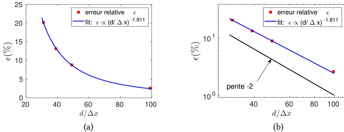
**FIGURE 2.26** – Convergence en maillage : variation de l'erreur relative sur la traînée adimensionnée avec résolution spatiale pour  $|\text{grad}(P)| = 5 \times 10^{-5}$  et  $Re \simeq 2.5$ , pour  $\phi = 0.514$ , et pour un arrangement cubique simple en échelle linéaire (a) et en échelle logarithmique (b). Le résultat de la simulation avec OpenFOAM est pris comme référence.
