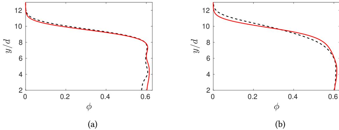
**FIGURE 4.35** – Profils moyens de fraction volumique solide  $\phi$  dans le régime permanent; (noir - -) : SANS; (rouge -) : AVEC, l’activation du modèle de lubrification (4.41) pour  $Re_p = 1$  et (a) :  $\theta = 0.22$ ; (b) :  $\theta = 0.67$ . La fraction volumique est calculée avec la méthode d’homogénéisation décrite dans la section 5.1, avec  $h_g = d$ .
