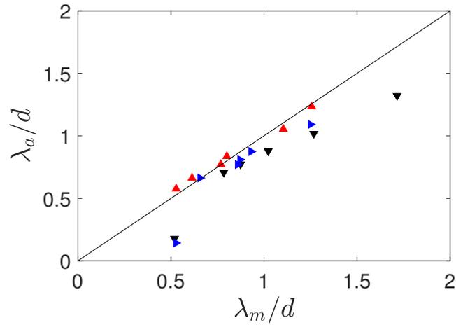
**FIGURE 5.29** –  $\lambda_a$  en fonction de  $\lambda_m$  pour tous les nombres de Shields  $\theta$  testés et pour ( $\blacktriangledown$ ) :  $Re_p = 0.1$ ; ( $\blacktriangleright$ ) :  $Re_p = 1$ ; ( $\blacktriangle$ ) :  $Re_p = 10$ .
