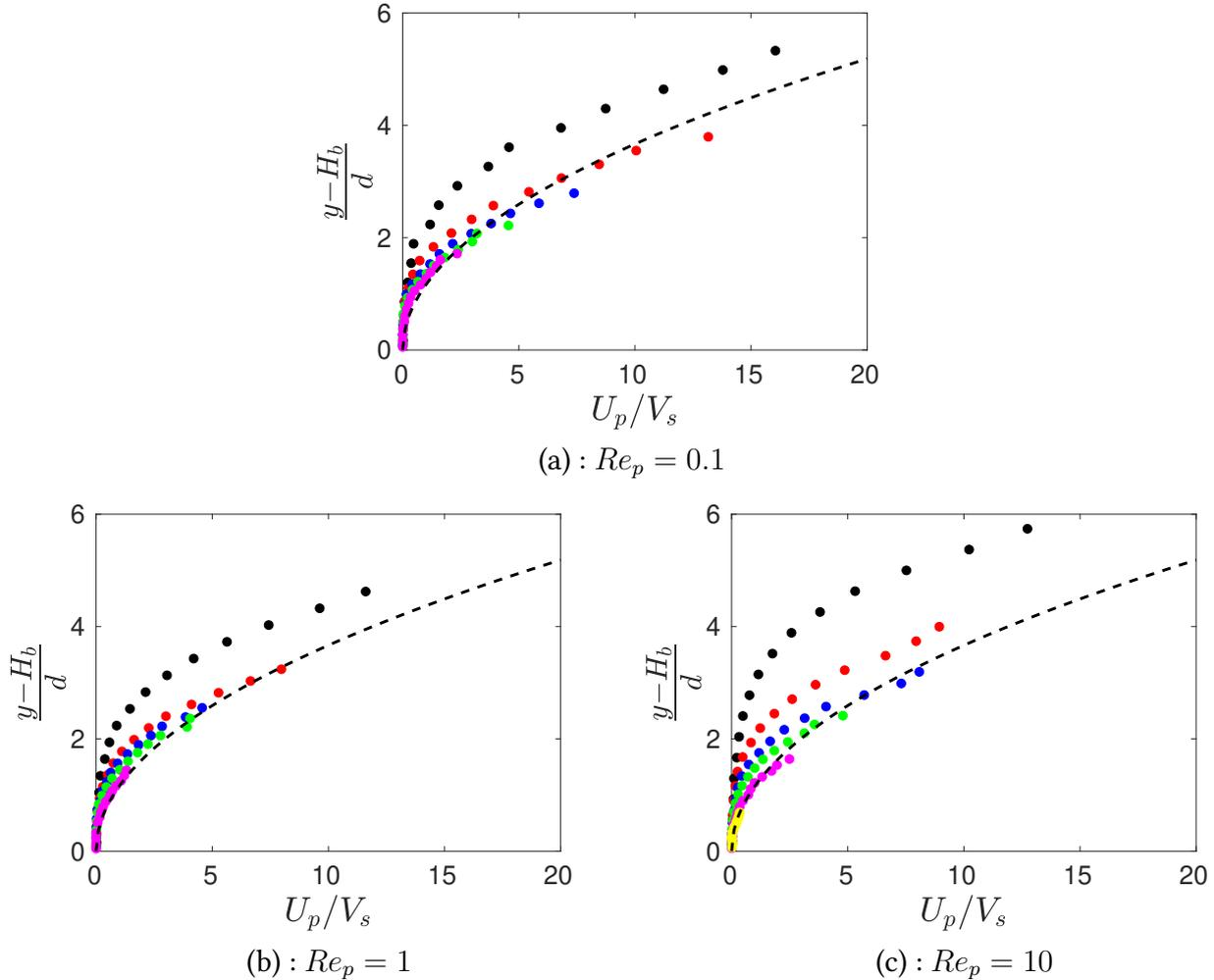
**FIGURE 4.11** – Profils de vitesse des grains adimensionnée par la vitesse de Stokes pour (a) :  $Re_p = 0.1$ , (b) :  $Re_p = 1$  et (c) :  $Re_p = 10$  (● :  $\theta = 0.66$ , ● :  $\theta = 0.50$ , ● :  $\theta = 0.40$ , ● :  $\theta = 0.33$ , ● :  $\theta = 0.22$  et ● :  $\theta = 0.11$ ). (- -) : profil parabolique du modèle de MOUILLERON *et al.* (2009) (équation (4.12)).
