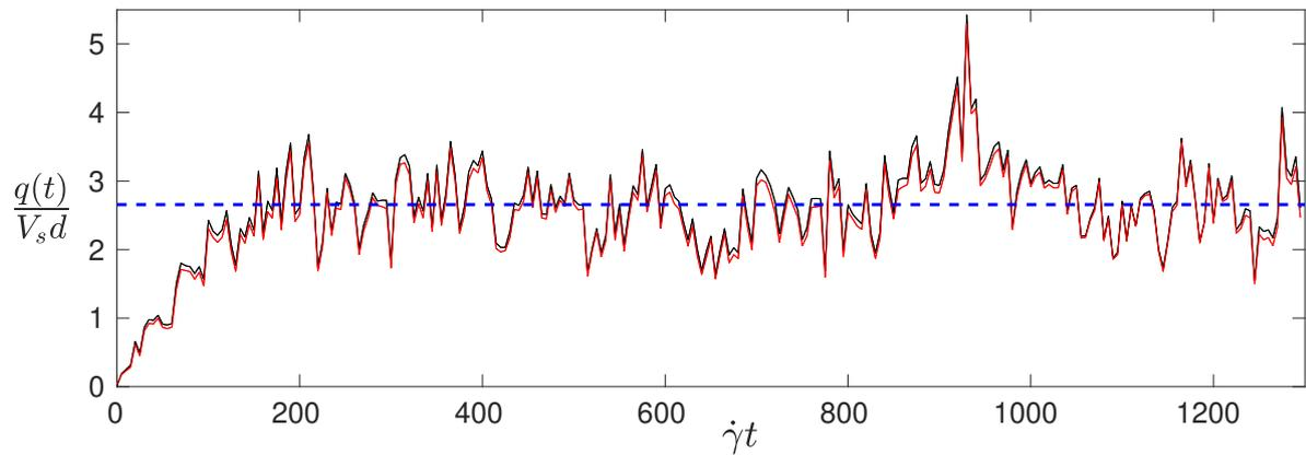
**FIGURE 3.2** – Évolution temporelle du débit granulaire pour  $Re_p = 1$ ,  $\theta = 0.67$  et  $r = 2.5$ . (–) :  $q_\alpha/V_s d$  via sa formulation eulérienne (équation (3.4)); (–) :  $q/V_s d$  via sa formulation lagrangienne (équation (3.3)). (–) : débit granulaire saturé. Seul un point tous les  $5\dot{\gamma}t$  est représenté ici. Le débit est adimensionné par le débit linéique  $V_s d$ , construit à partir de la vitesse de Stokes  $V_s = \frac{(\rho_p - \rho_f)gd^2}{18\eta_f}$ .
