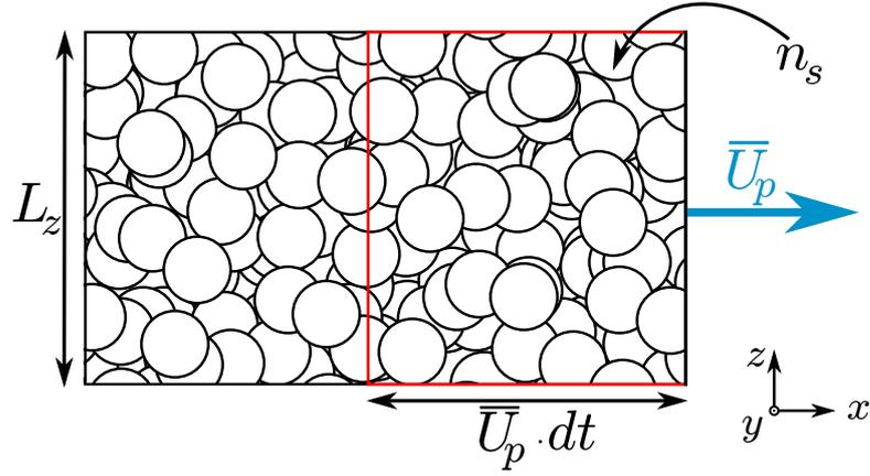
**FIGURE 4.3** – Schéma représentant une portion de largeur  $L_z$  du lit de grains vue du dessus.  $\bar{U}_p$  est à la vitesse moyenne des grains mobiles et  $n_s$  leur densité surfacique. Les particules qui traversent la surface de droite (celle où la vitesse  $\bar{U}_p$  est représentée) pendant la durée  $dt$  correspondent alors aux grains contenus dans le cadre rouge.
