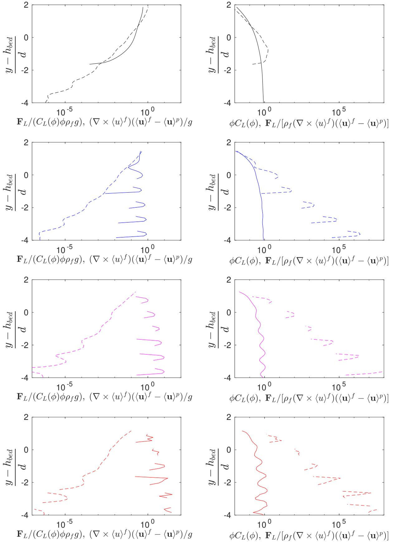
**FIGURE 5.15** – (colonne de gauche) :  $\mathbf{F}_L / (C_L(\phi)\phi\rho_f g)$  en traits pleins (–) et  $(\nabla \times \langle u \rangle^f)(\langle \mathbf{u} \rangle^f - \langle \mathbf{u} \rangle^p) / g$  en pointillés (– –) pour (1<sup>ère</sup> ligne –) :  $h_g = d$ ; (2<sup>ième</sup> ligne –) :  $h_g = d/2$ ; (3<sup>ième</sup> ligne –) :  $h_g = d/4$ ; (4<sup>ième</sup> ligne –) :  $h_g = d/10$ .
