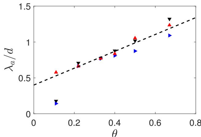
**FIGURE 5.26** – Longueur de glissement  $\lambda_a$ , adimensionnée par le diamètre des grains  $d$ , en fonction du nombre de Shields  $\theta$  pour ( $\blacktriangledown$ ) :  $Re_p = 0.1$ ; ( $\blacktriangleright$ ) :  $Re_p = 1$ ; ( $\blacktriangle$ ) :  $Re_p = 10$ . (- -) : ajustement linéaire (équation (5.76)).
