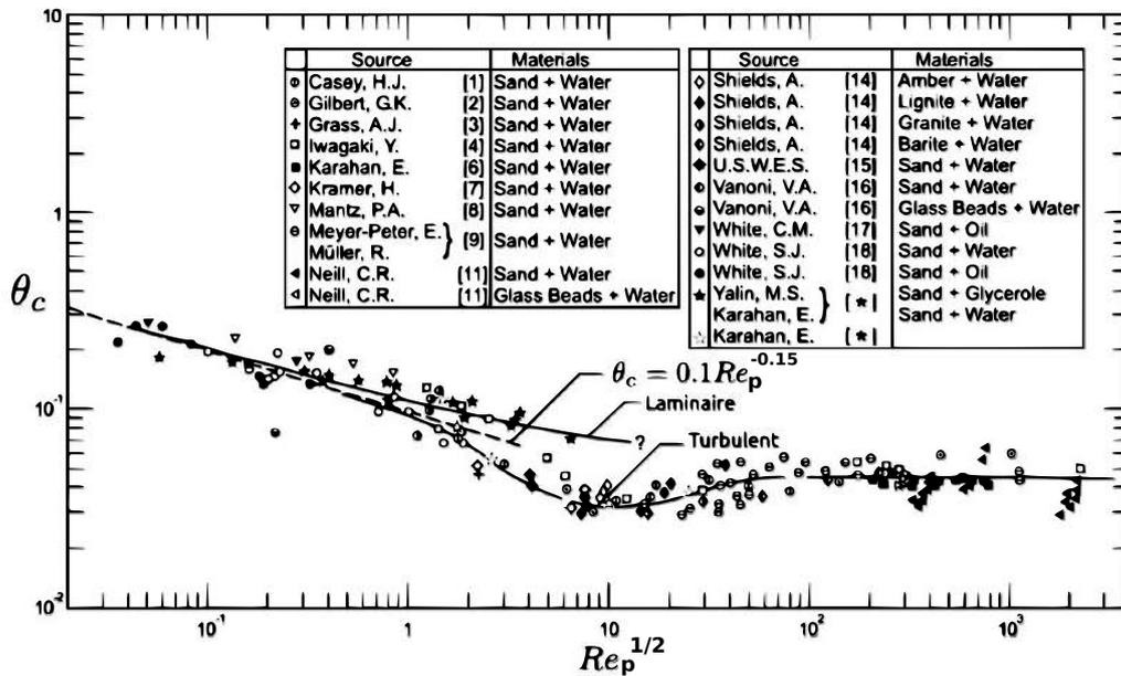
FIGURE 1.4 – Nombre de Shields critique  $\theta_c$  en fonction du nombre de Reynolds particulaire  $Re_p$ .
