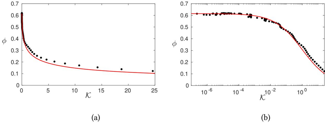
**FIGURE 5.19** – Fraction volumique de grains  $\phi$  en fonction du nombre  $\mathcal{K}$ , (a) : en échelle linéaire; (b) : en échelle logarithmique. (•) : étude présente, (–) : ajustement de la relation (5.54),  $\phi_c = 0.615$ .
