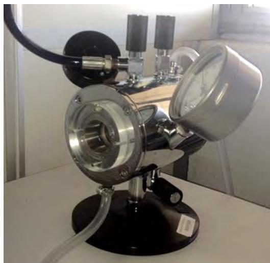
Figure 19 Photo du sécheur CO<sub>2</sub> supercritique
