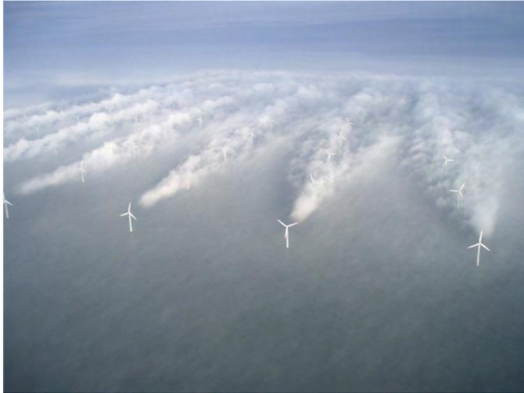
FIG. 1.1 : Condensation spontanée du parc offshore de Horns Rev 1, Danemark ©Vattenfall
