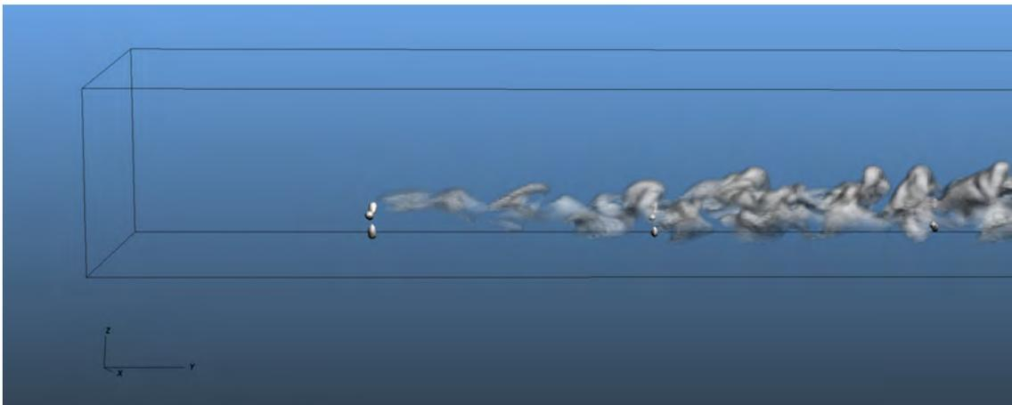
FIG. 7.3 : Tracé 3D d'iso-contours du rapport de mélange d'eau nuageuse  $r_c$  (gris). Les pales d'éoliennes sont représentées en blanc.
