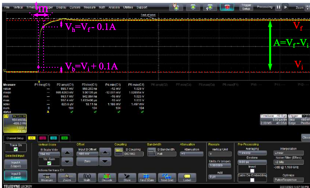
Figure 3-9: Capture de l'oscilloscope LECROY SDA-813zi [107] lors de la mesure du temps de montée du montage présenté en Figure 3-7.
