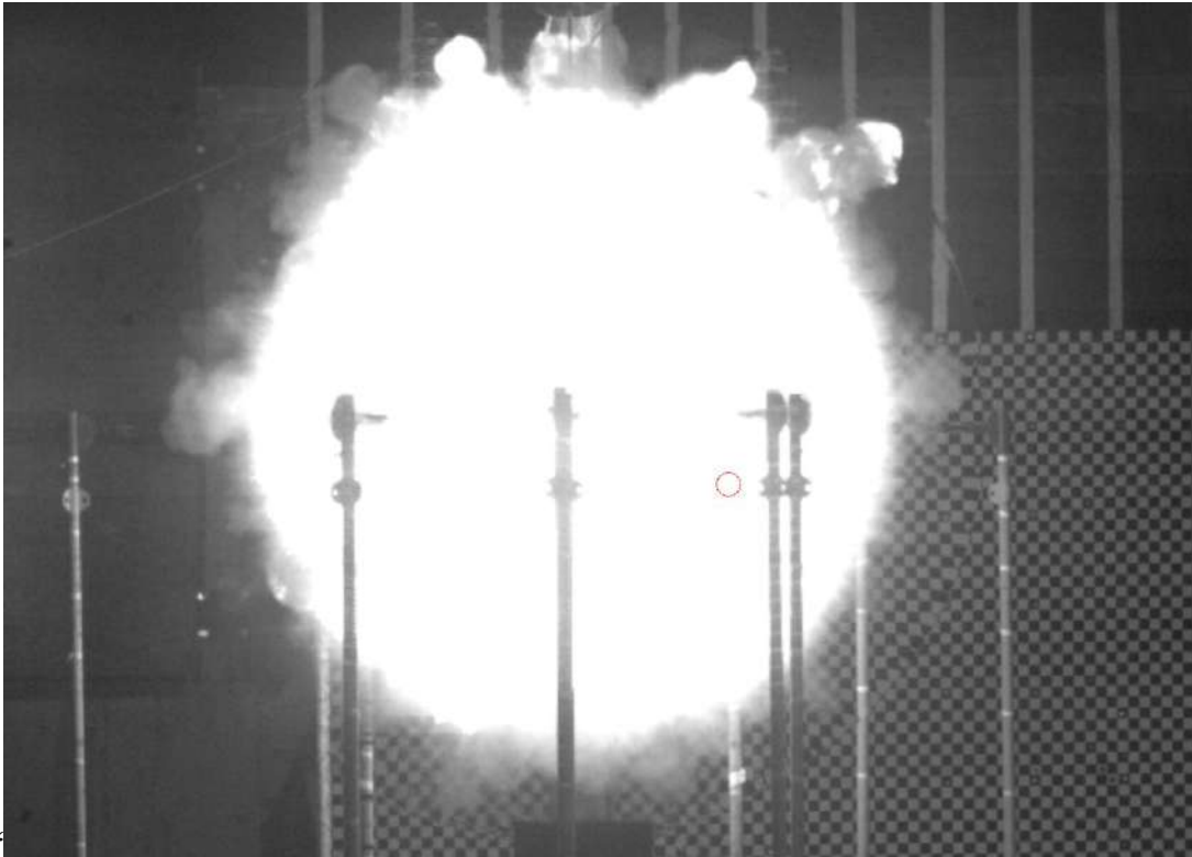
Figure 5-34: Image de l'explosion d'environ 600 g de TNT aluminisé, 1,15 ms après l'initiation de la charge. La position de l'émetteur RF du système sans fil est représentée par le cercle rouge.
