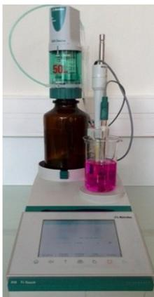
*Figure 17. Dispositif de dosage (Ti-Touch 916)*
